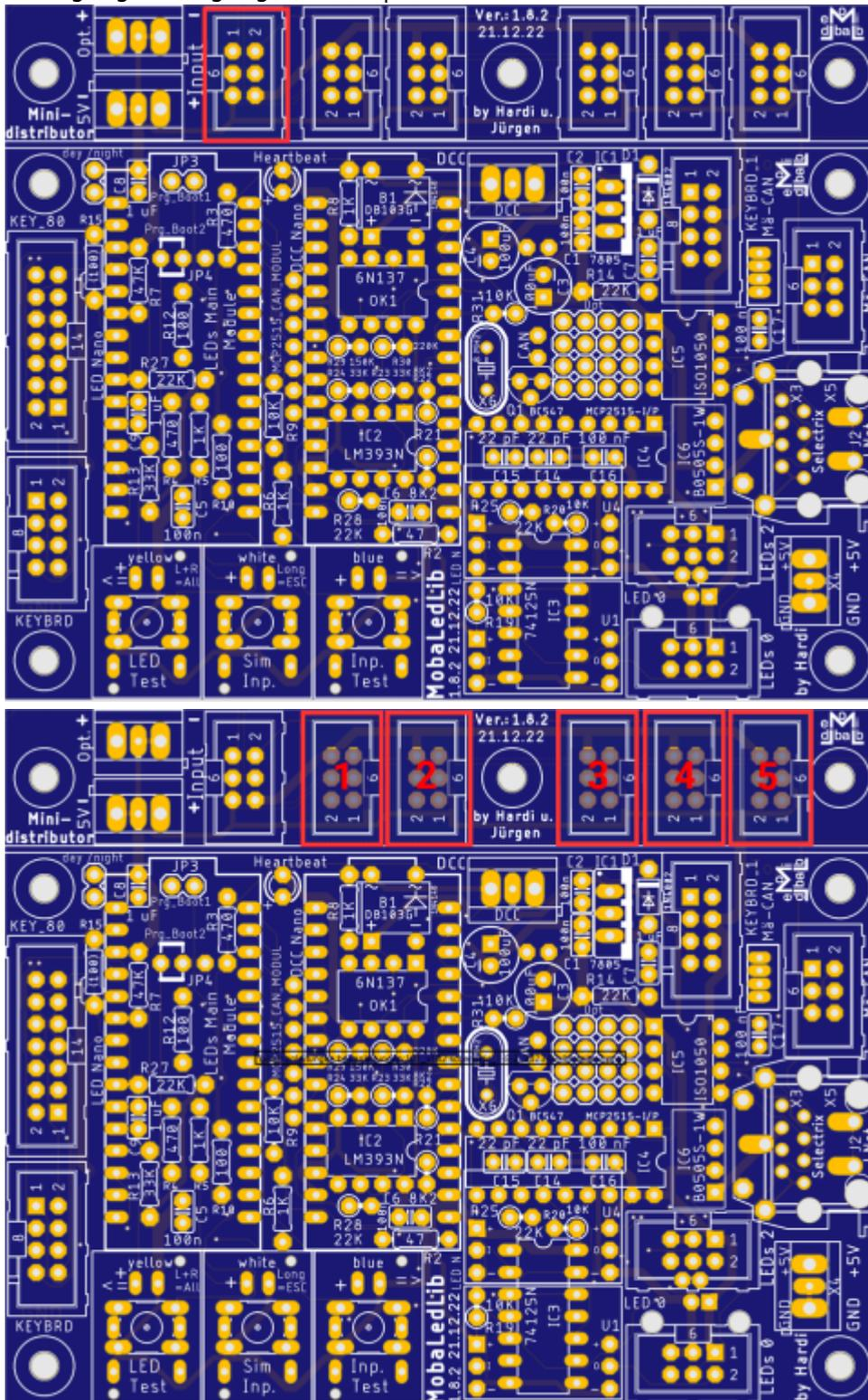
Danach werden die beiden Schraubklammern eingelötet.
