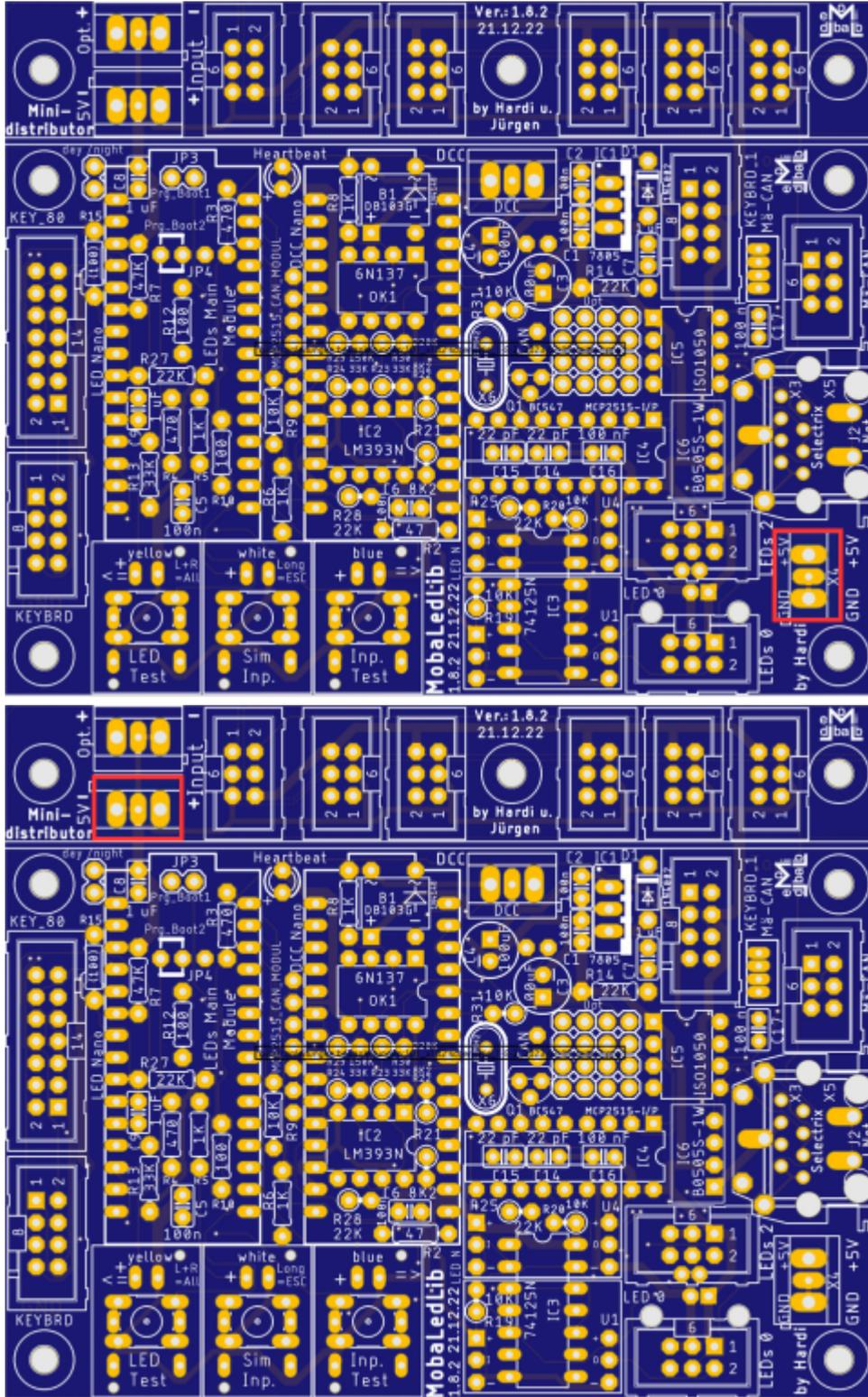
Sollte der Mini-Distributor von der Hauptplatine getrennt worden sein, bitte den Lötjumper<color #22b14c> „**MINI\_VERT**“ (grün) schließen. Der Lötjumper „J3“ verbindet den Pin1 und Pin6 der Wannenstecker. **Nicht schließen, wenn mehr als 5V am opt. Eingang oder am Pin6 anliegen.**[weitere Infos](#)
