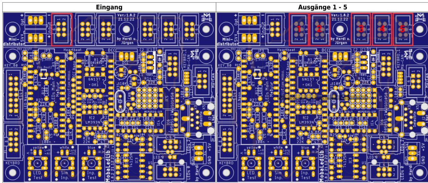
Danach werden die beiden Schraubklemmen eingelötet.
