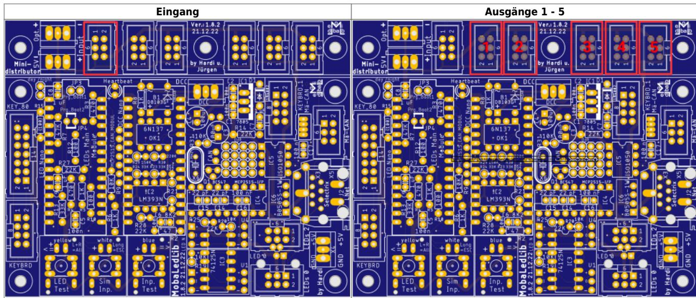
Danach werden die beiden Schraubklemmen eingelötet.
