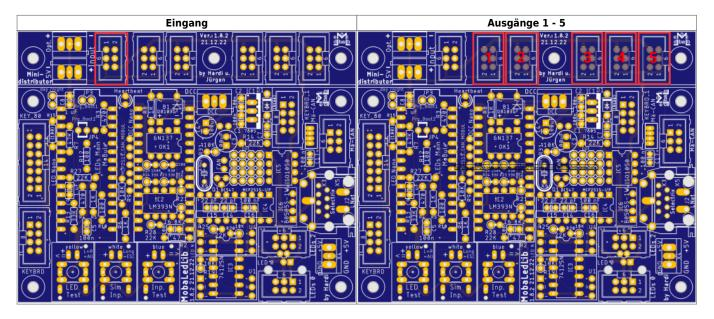
Danach werden die beiden Schraubklemmen eingelötet.
