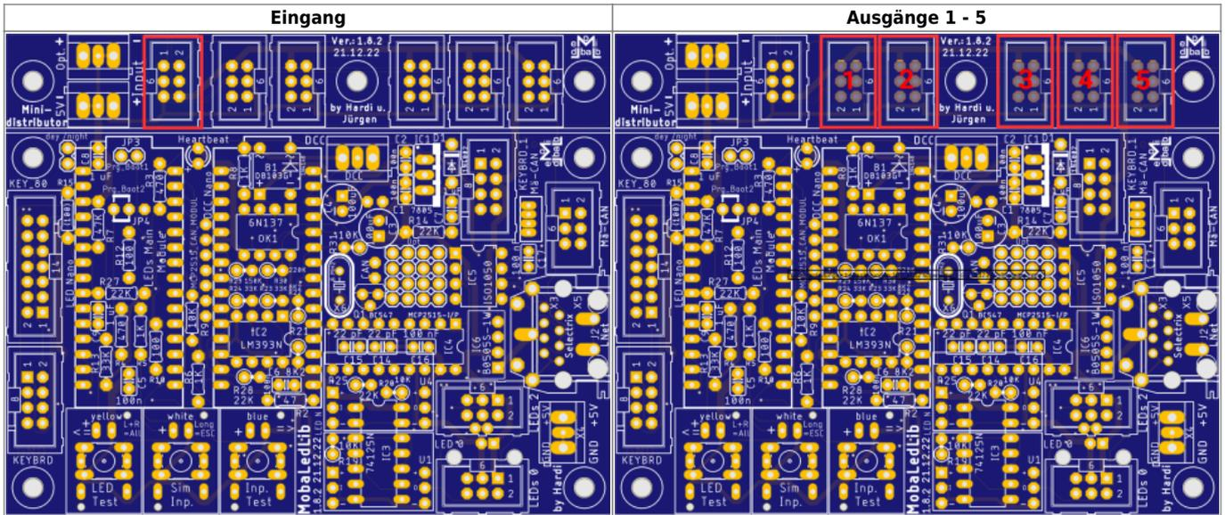
Danach werden die beiden Schraubklemmen eingelötet.
