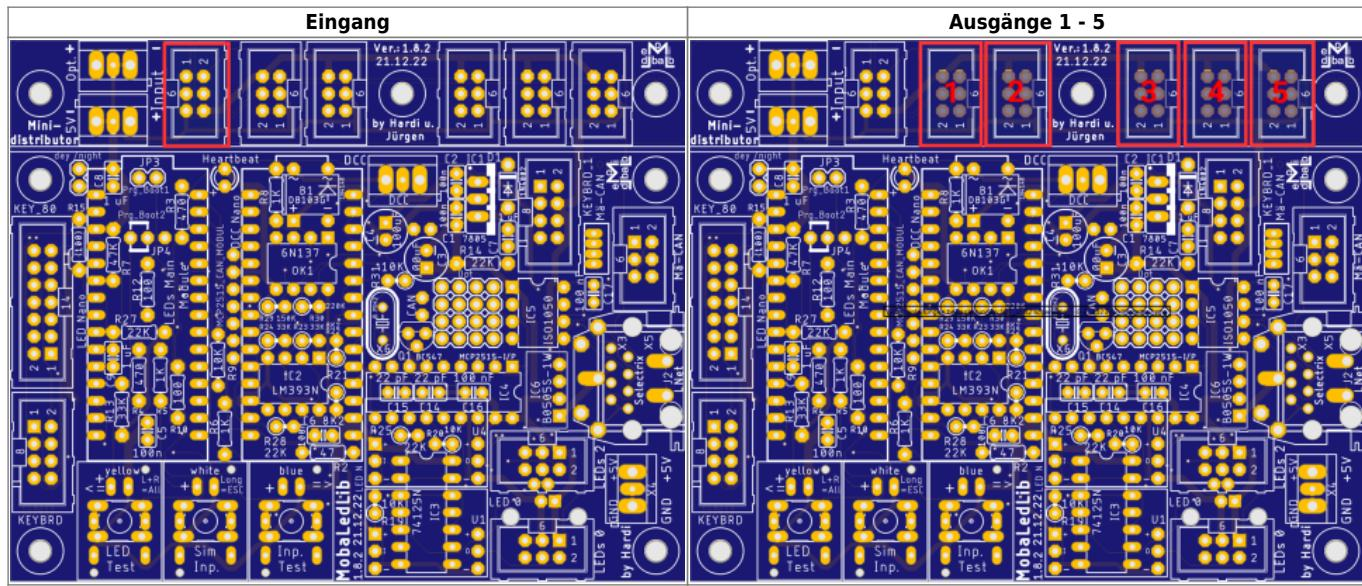
Danach werden die beiden Schraubklemmen eingelötet.
