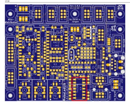
Die nächsten Bauteile sind die vier Buchsenleisten für die beiden Arduinos. Damit diese passen, müssen die Leisten, sollte man die aus dem Reichelt Warenkorb gekauft haben, auf 15 Pole gekürzt werden.
