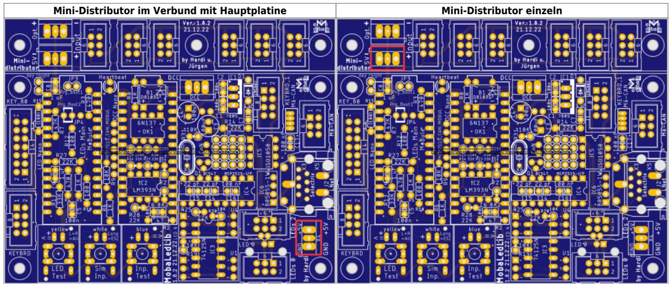
Sollte der Mini-Distributor von der Hauptplatine getrennt worden sein, bitte den Lötjumper „**MINI\_VERT**“ (grün) schließen. Der Lötjumper „J3“ verbindet den Pin1 und Pin6 der Wannenstecker. Nicht schließen, wenn mehr als 5V am opt. Eingang oder am Pin6 anliegen.[weitere Infos](#)
