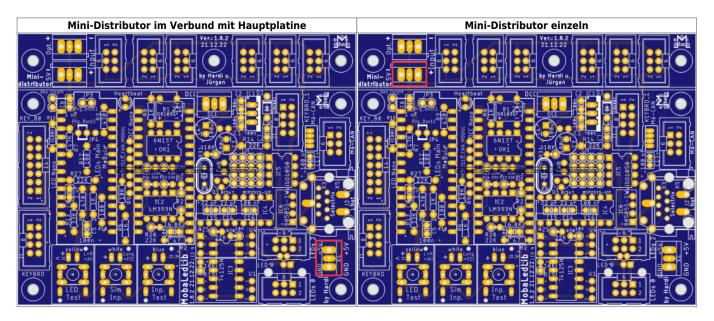
Sollte der Mini-Distributor von der Hauptplatine getrennt worden sein, bitte den Lötjumper "MINI\_VERT" (grün) schließen. Der Lötjumper "J3" verbindet den Pin1 und Pin6 der Wannenstecker. Nicht schließen, wenn mehr als 5V am opt. Eingang oder am Pin6 anliegen.weitere Infos
