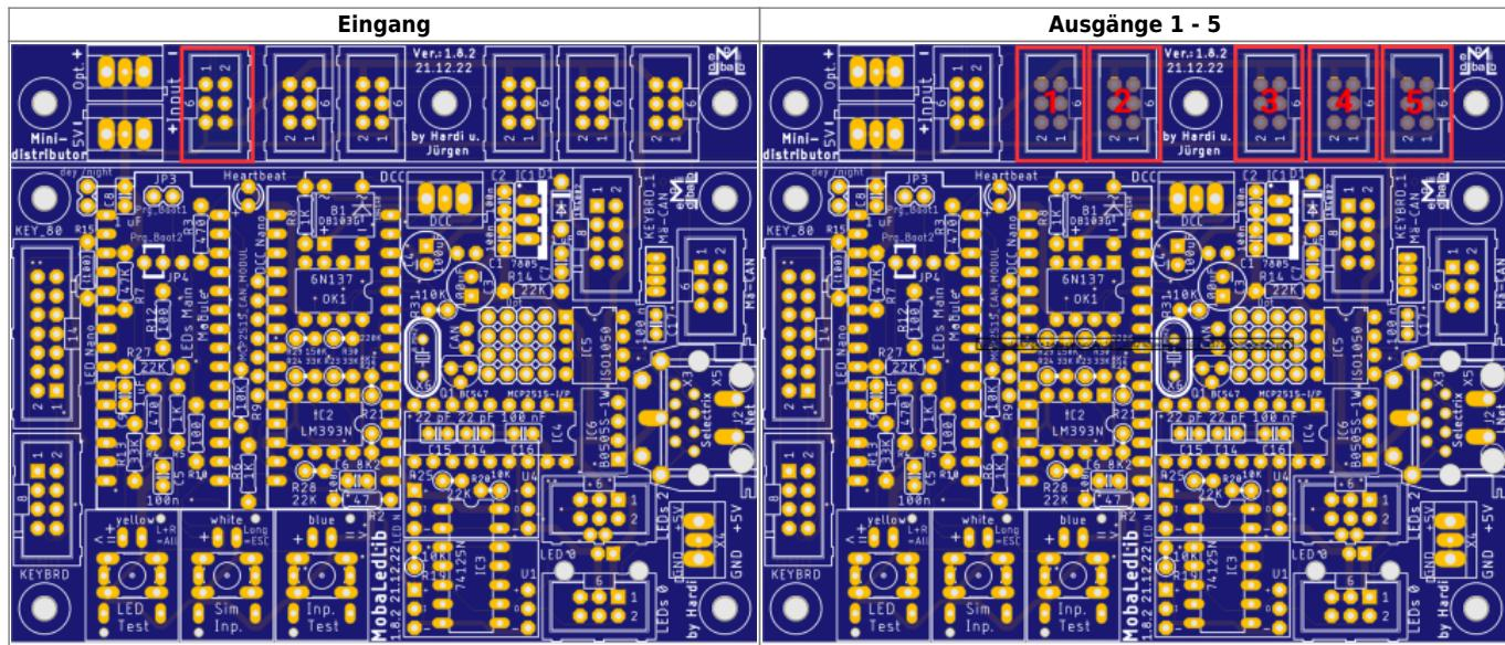
Danach werden die beiden Schraubklemmen eingelötet.
