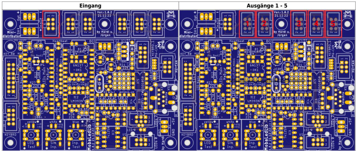
Danach werden die beiden Schraubklemmen eingelötet.
