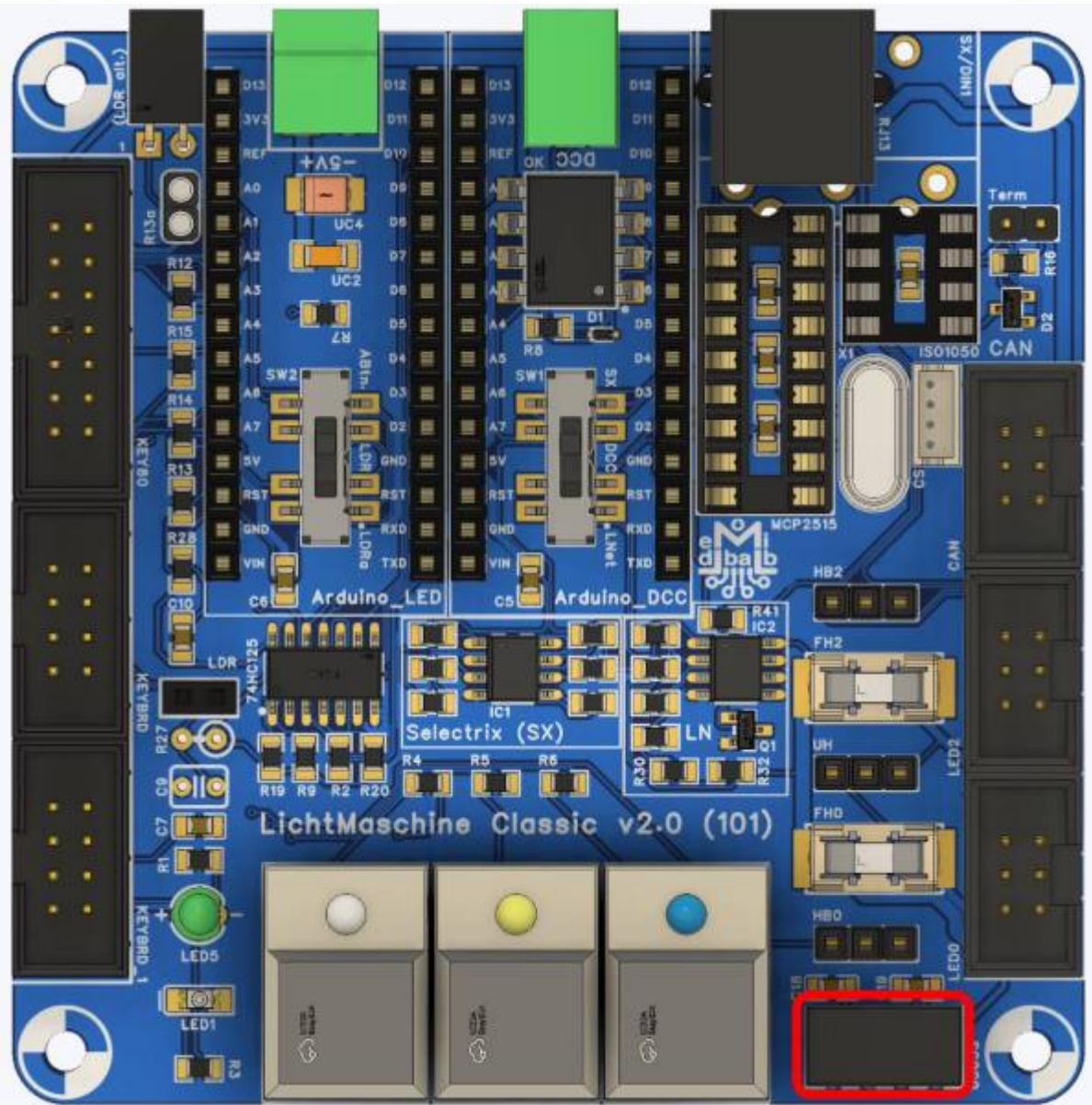
Da nun alle Bauteile eingelötet sind, kann das Heartbeat Breakout in die Buchsen eingesteckt werden. Ggf. müssen die Stiftleisten noch gelötet werden. Das gelingt im eingesteckten Zustand am besten.
