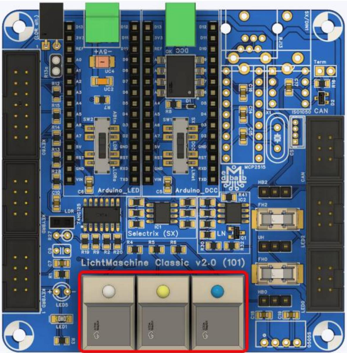
Wer die Platine für Selectrix baut, kann an dieser Stelle den DIN-Stecker einlöten.
