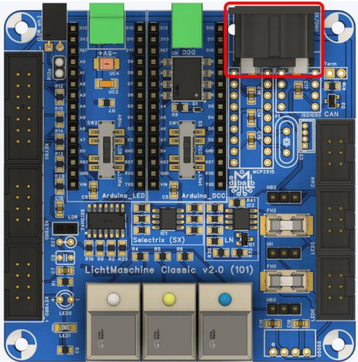
Stattdessen wird an dieser Stelle die RJ13-Buchse für Lnet montiert.
