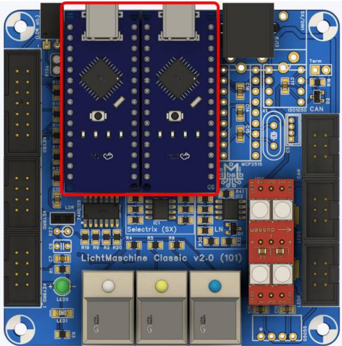
Für den Fall, dass anstelle des LDR-Sensors lieber analoge Taster verwendet werden sollen, müssen die Bauteile R27 und C9 eingelötet werden.
