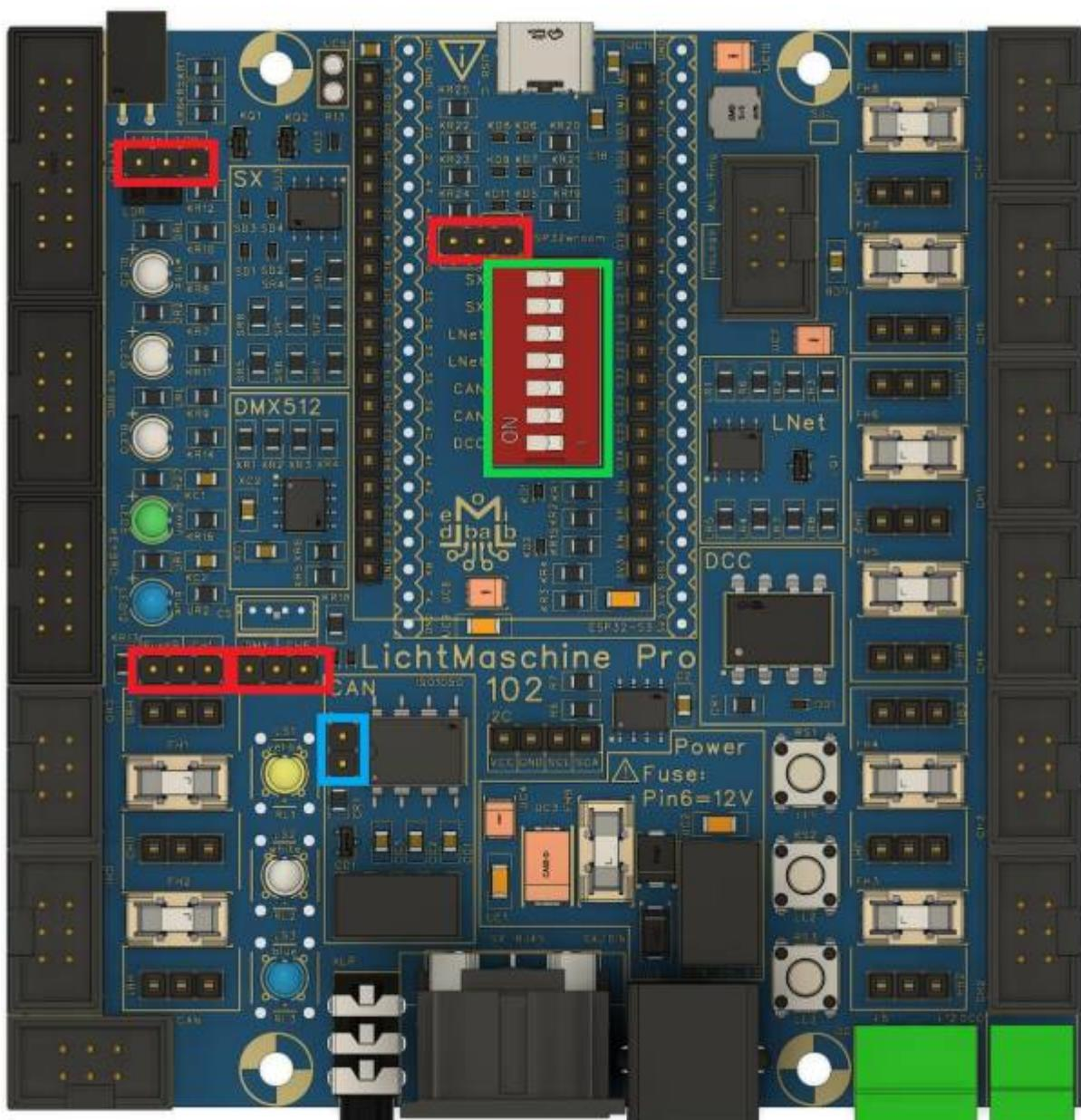
Danach werden die **Wannenstecker** eingelötet. Hier ist auf die richtige Ausrichtung zu achten. Die Buchse für den **MLL-Ring** kann ggf. unbestückt bleiben, wenn der MLL-Ring nicht verwendet wird. Genauso kann ggf. die Buchse für den **CAN-Bus** entfallen. Am besten lötet man zuerst nur einen Pin an, während man dann den Pin wieder erwärmt und die Buchse ganz auf die Platine drückt.
