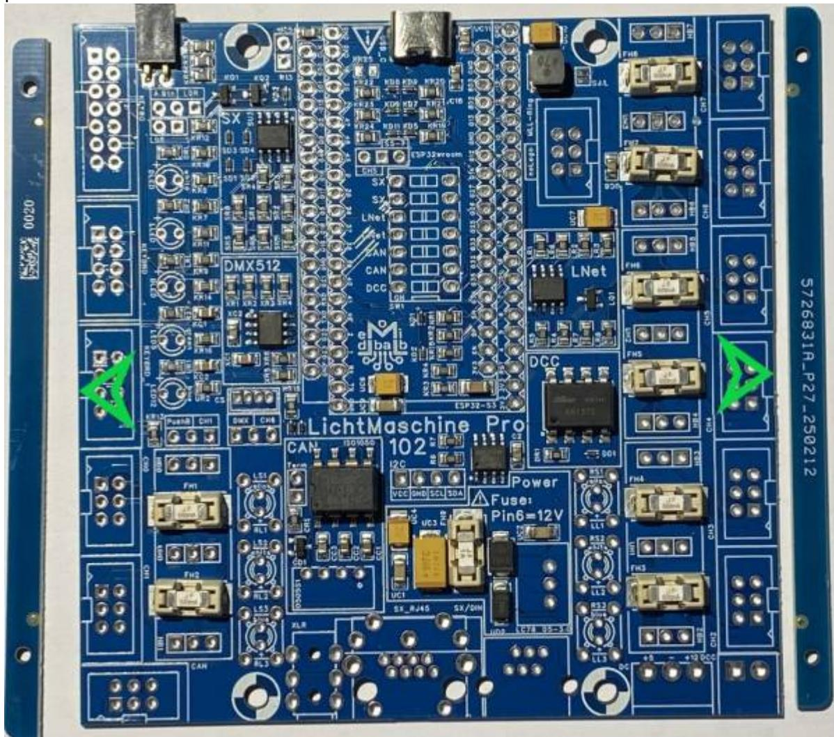
Den Anfang macht die **USB-C-Buchse** und die **2-polige Buchse mit den gebogenen Beinchen** (für den externen LDR), sie sind die niedrigsten Teile. Es ist darauf zu achten, dass die Metalllaschen des USB-C-Gehäuses gut verlötet werden und es keine kalte Lötlöcke gibt. Sonst ist die mechanische Festigkeit der Buchse gefährdet.
