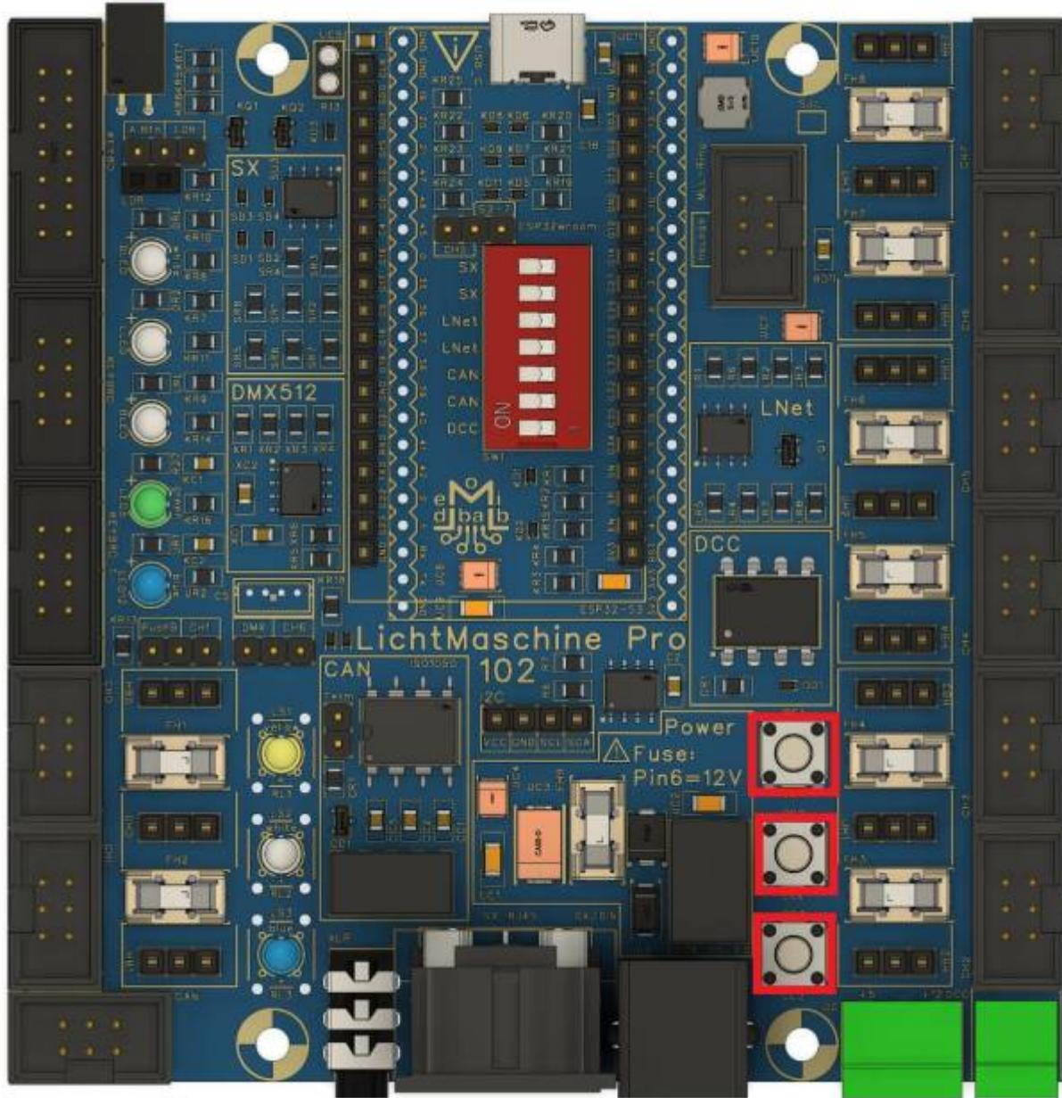
Als letztes wird noch die **LNet-Buchse** für den LocoNet-Anschluß eingelötet.
