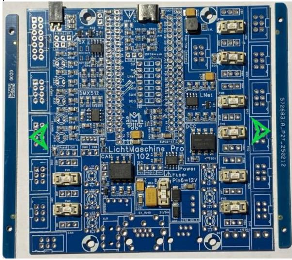
Den Anfang macht die **USB-C-Buchse** und die **2-polige Buchse mit den gebogenen Beinchen** (für den externen LDR), sie sind die niedrigsten Teile. Es ist darauf zu achten, dass die Metalllaschen des USB-C-Gehäuses gut verlötet werden und es keine kalte Lötstelle gibt. Sonst ist die mechanische Festigkeit der Buchse gefährdet.
