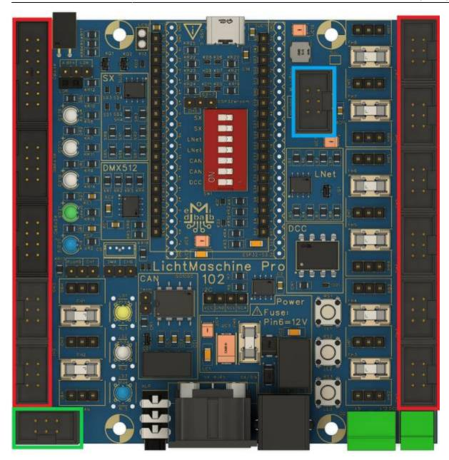
Danach werden die 12 **Buchsenleisten 3-polig** für die Breakout-Module eingelötet.
