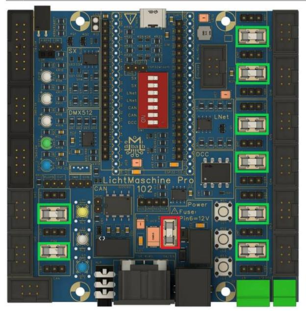
Weiter werden die DMX-Buchse (Buchse hat je nach Lieferant 5 bzw 6 Pins.), die 2-polige Stiftleise für DCC und die 3-polige Stiftleiste für die Stromversorgung bestückt (das sind die, die für die steckbaren Schraubklemmen eingebaut werden) .
