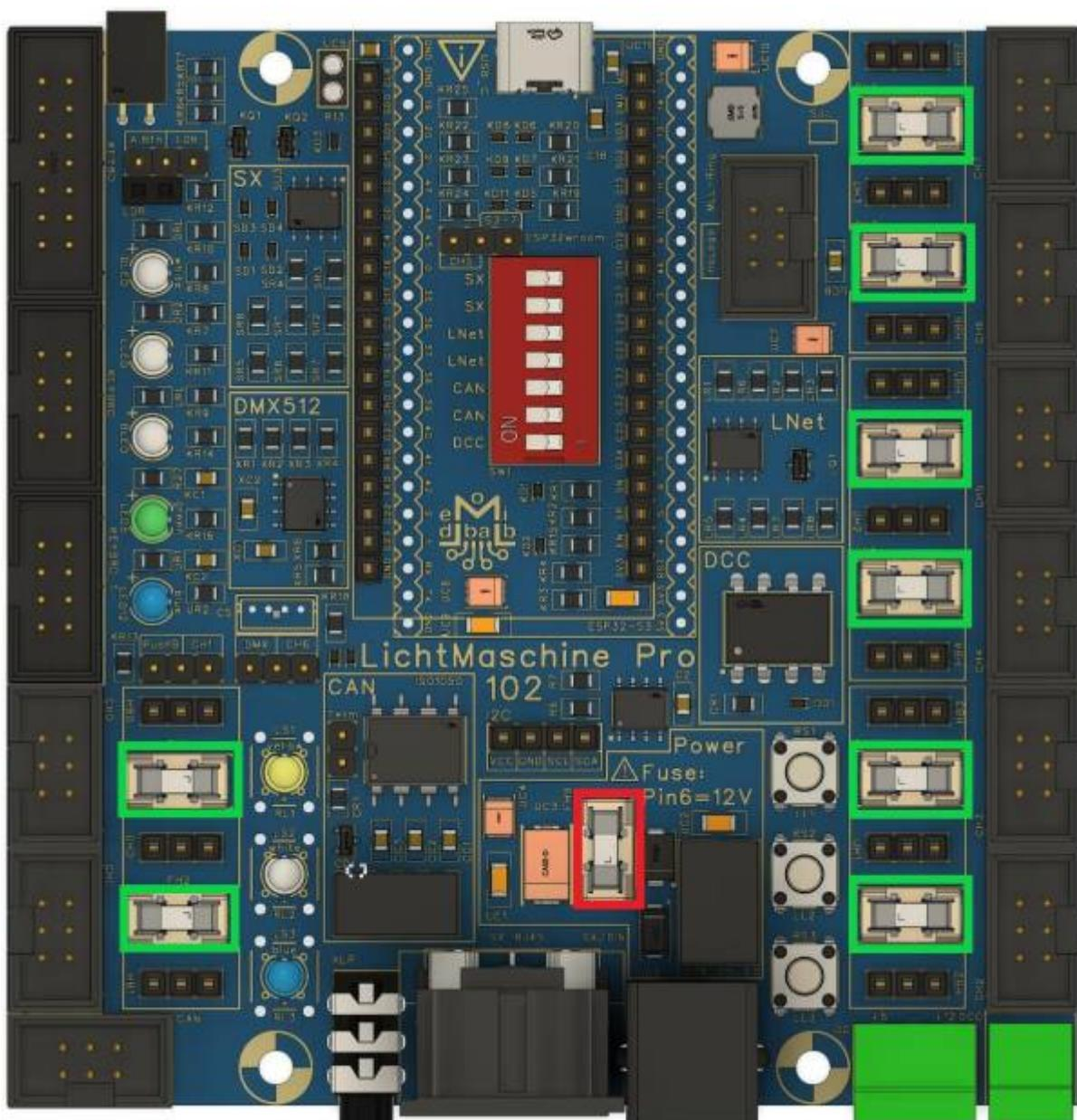
Weiter werden die **DMX-Buchse** (Buchse hat je nach Lieferant 5 bzw 6 Pins.), die **2-polige Stifteleise** für DCC und die **3-polige Stifteleiste** für die Stromversorgung bestückt (das sind die, die für die steckbaren Schraubklemmen eingebaut werden) .
