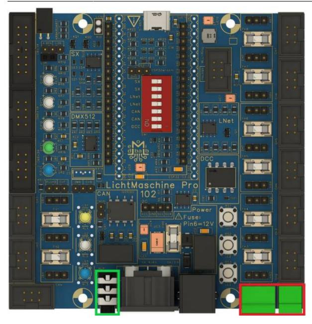
Gefolgt vom **DIP-Schalter** und den **2-** bzw. **3-poligen Stiftleisten**. Beim einlöten des DIL-Schalters alle auf "off" stellen
