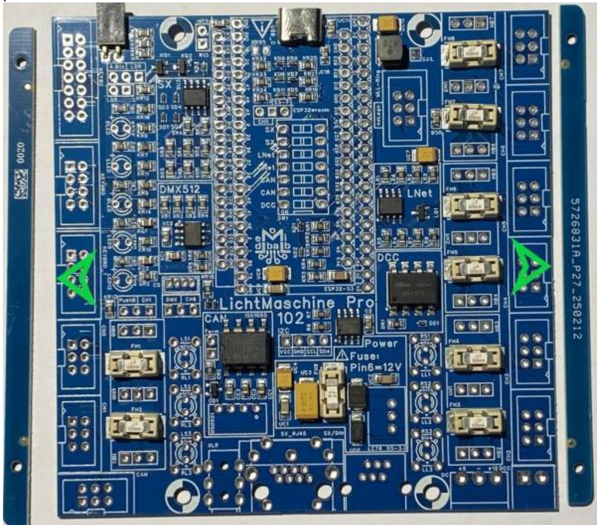
Den Anfang macht die **USB-C-Buchse** und die **2-polige Buchse mit den gebogenen Beinchen** (für den externen LDR), sie sind die niedrigsten Teile. Es ist darauf zu achten, dass die Metalllaschen des USB-C-Gehäuses gut verlötet werden und es keine kalte Lötstelle gibt. Sonst ist die mechanische Festigkeit der Buchse gefährdet.
