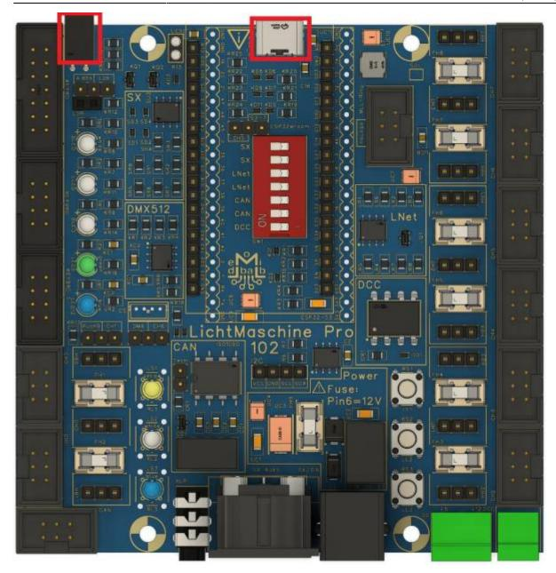
Es können auch die 8 Sicherungen **500 mA** für die LED-Kanäle eingesetzt werden. Achtung beim Auspacken, die Teile können leicht fortspritzen.
