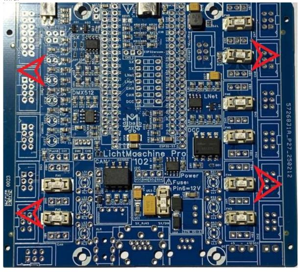
Diese zwei Streifen können mit einer Flachzange einfach vorsichtig abgebrochen werden. Erst dann passt die Platine ins Gehäuse.
