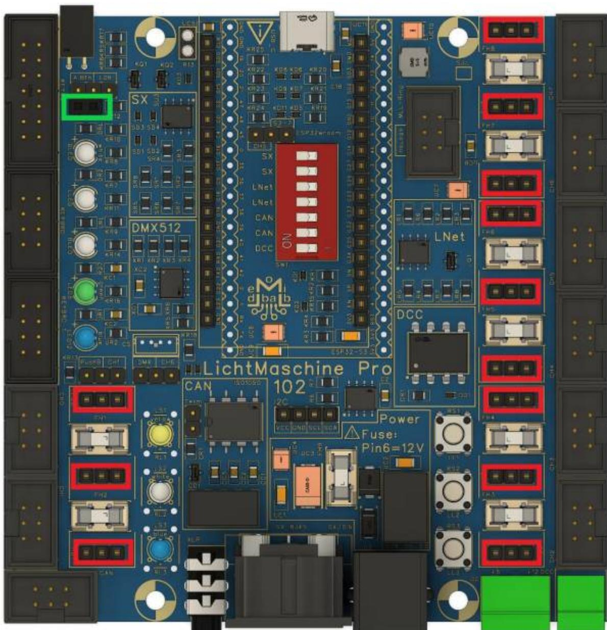
Dann werden die **19-poligen** und ggf. auch die **22-poligen Buchsenleisten** eingelötet. Die 22-poligen Buchsenleisten sind Vorarbeit für den ESP32 S3, der in Zukunft einmal verwendet werden könnte. Daher kann im Moment auf sie verzichtet werden. Sonst besteht die Gefahr, dass der ESP32 falsch gesteckt wird.
