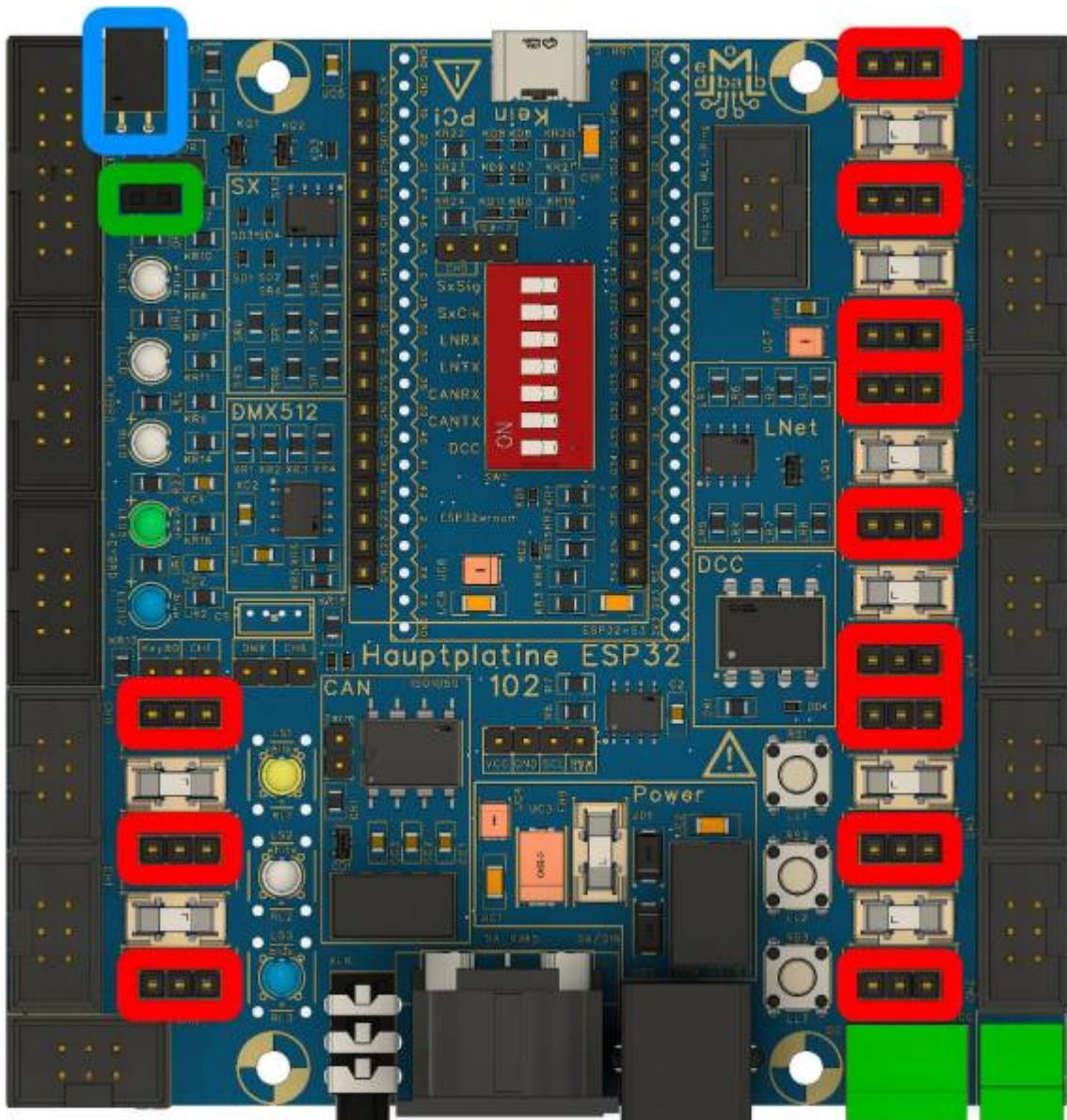
Dann werden die **19-poligen** und ggf. auch die **22-poligen Buchsenleisten** eingelötet. Die 22-poligen Buchsenleisten sind Vorarbeit für den ESP32 S3, der in Zukunft einmal verwendet werden könnte.
