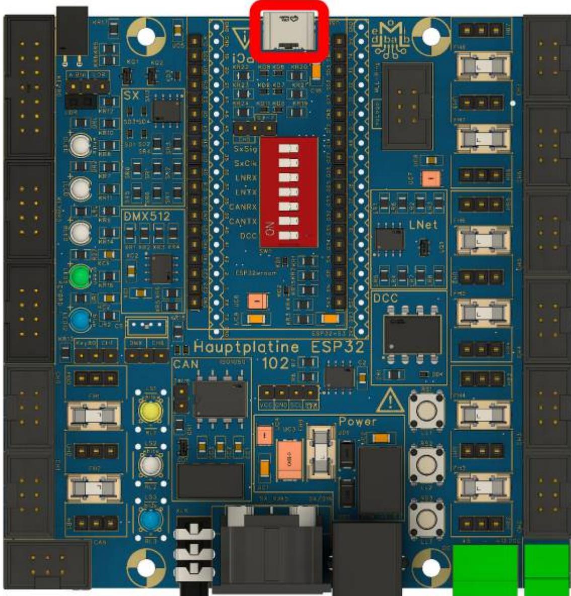
Es können auch die Sicherungen eingesetzt werden. Achtung beim Auspacken, die Teile können leicht fortspritzen. Wichtig ist auch, dass die **1 Ampere-Sicherung** an der richtigen Stelle eingesetzt wird.
