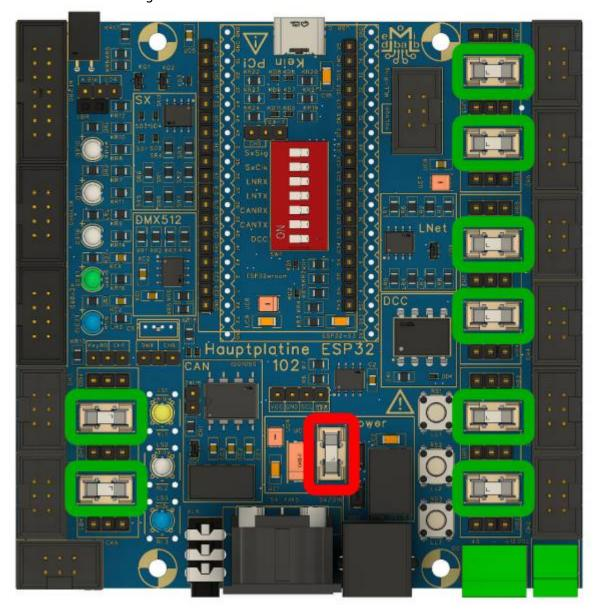
Weiter werden die **DMX-Buchse**, die **2-polige Stiftleise** für DCC und die **3-polige Stiftleiste** für die Stromversorgung bestückt.
