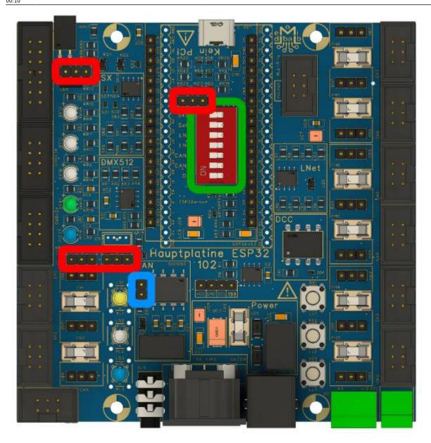
Danach werden die **Wannenstecker** eingelötet. Hier ist auf die richtige Ausrichtung zu achten. Die Buchse für den **MLL-Ring** kann ggf. unbestückt bleiben, wenn der MLL-Ring nicht verwendet wird. Genauso kann ggf. die Buchse für den **CAN-Bus** entfallen.
