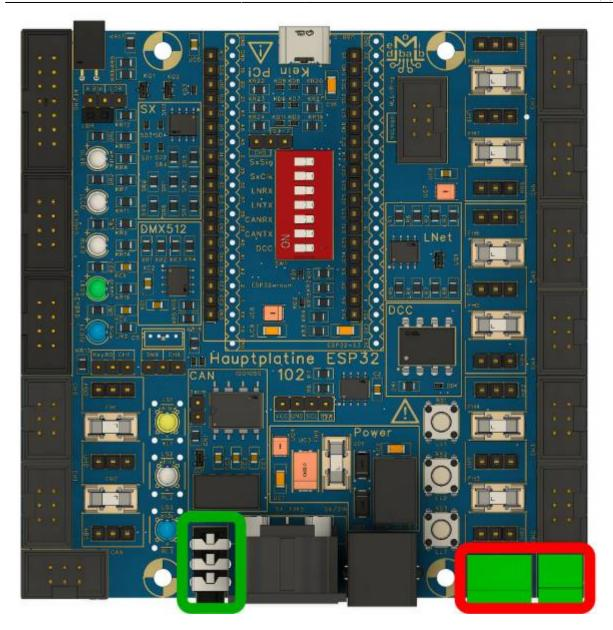
Gefolgt vom **DIL-Schalter** und den **2-** bzw. **3-poligen Stiftleisten**. Beim einlöten des DIL-Schalters alle auf "off" stellen
