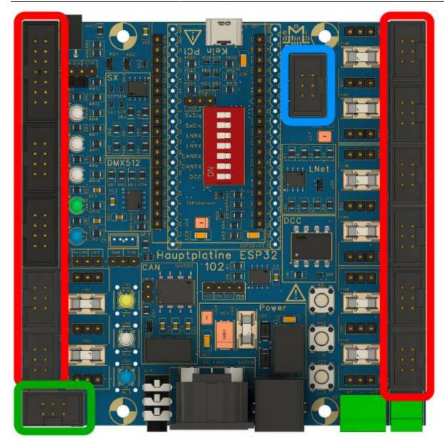
Danach werden die 12 **Buchsenleisten 3-polig** für die Breakout-Module eingelötet.
