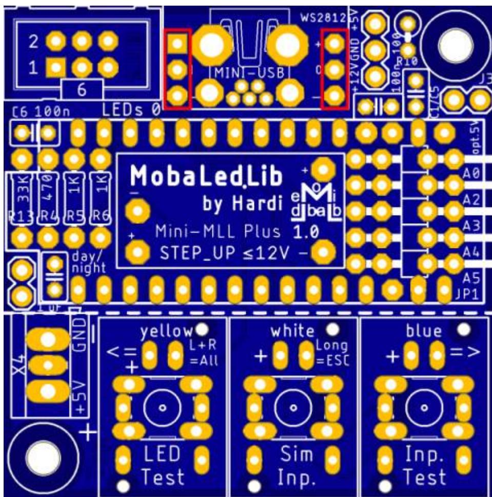
Nun folgt der Anschluss für die 5 Volt-Versorgung über die Schraubklemme.
