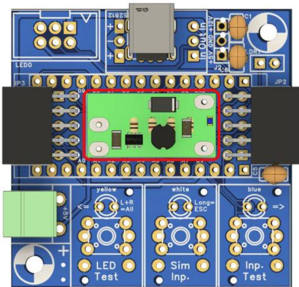
Die nächsten Bauteile sind die beiden Buchsenleisten für den Arduino. Damit diese passen, müssen die Leisten, sollte man die aus dem Reichelt Warnkorb gekauft haben, auf 15 Pole gekürzt werden.
