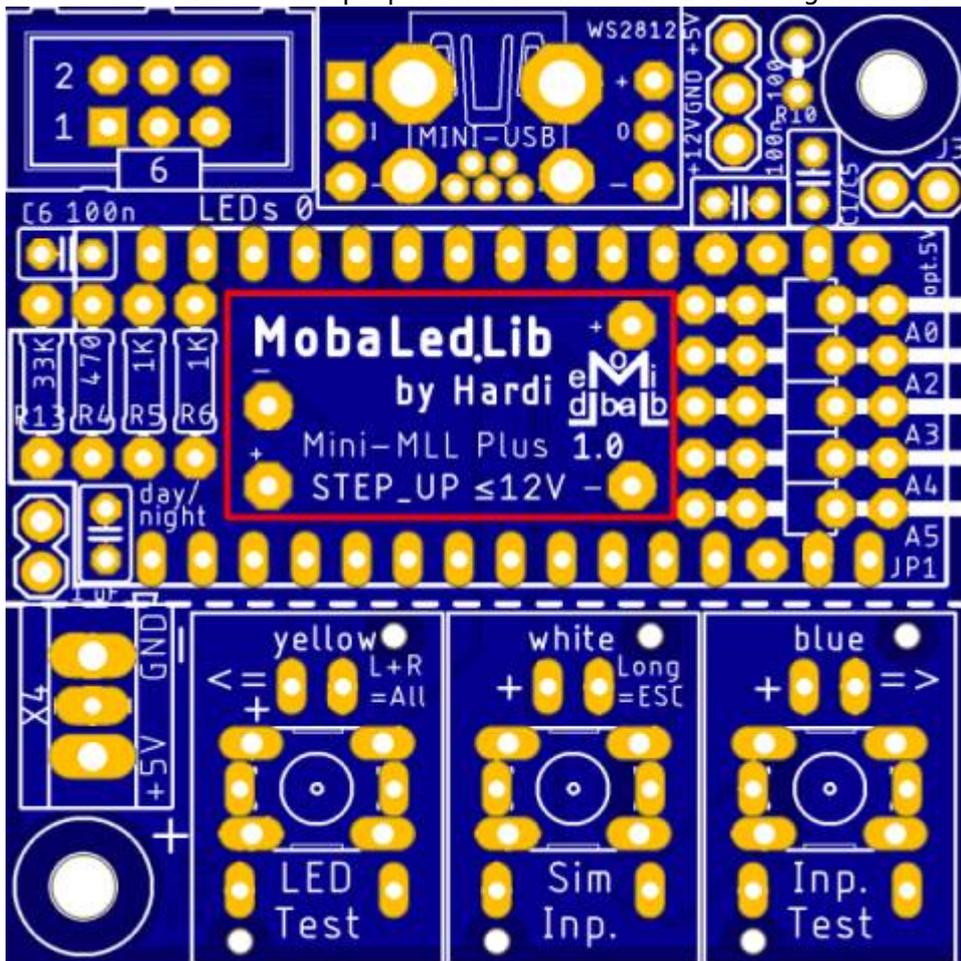
Die nächsten Bauteile sind die beiden Buchsenleisten für den Arduino. Damit diese passen, müssen die Leisten, sollte man die aus dem Reichelt Warnkorb gekauft haben, auf 15 Pole gekürzt werden.
