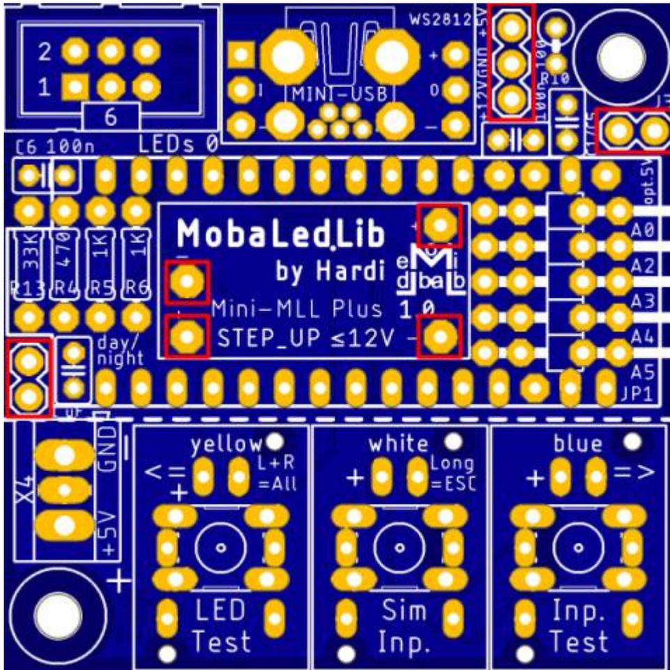
Als nächstes wird der Step Up Wandler auf die die zuvor eingelöteten Stiftleisten gelötet.
