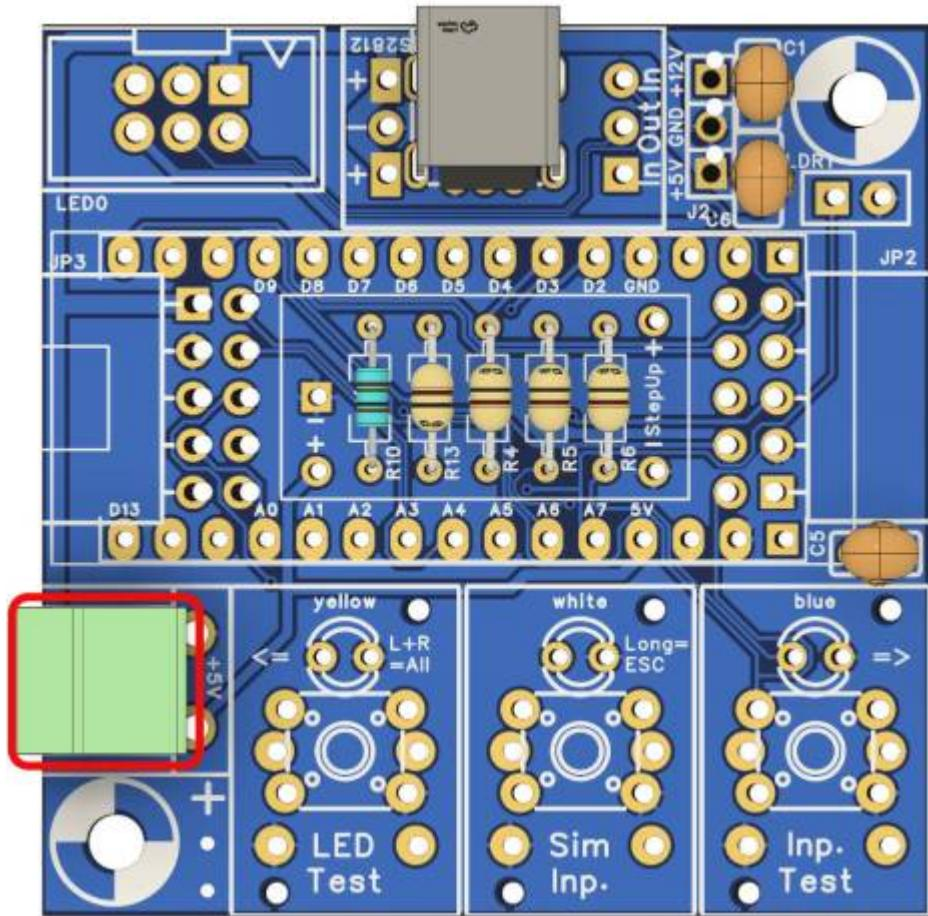
Die beiden zehnpoligen Buchsenleisten sollten noch vor den Arduino-Buchsenleisten montiert werden.
