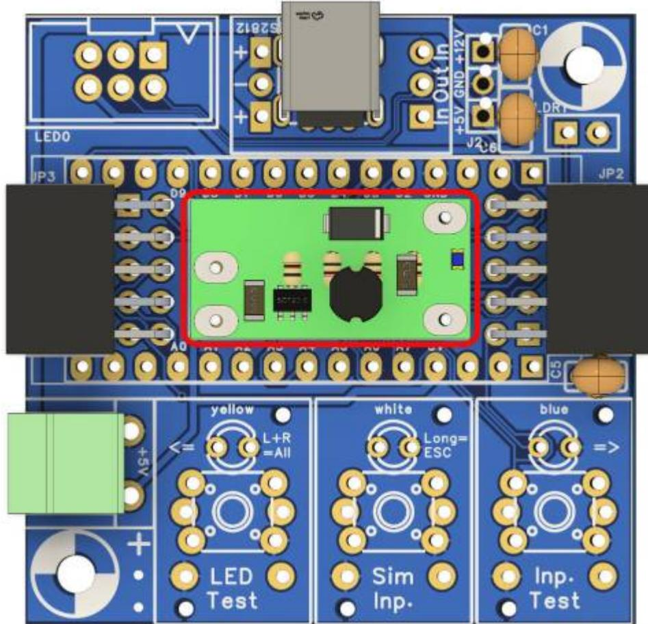
Die nächsten Bauteile sind die beiden Buchsenleisten für den Arduino.
