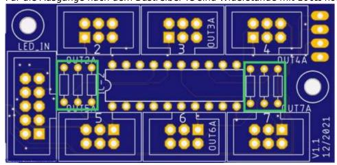
Um Platz zu sparen wurde diese nicht der Reihe nach auf der Platine verteilt. Die Zuordnung der Widerstände ist hier zu sehen.
