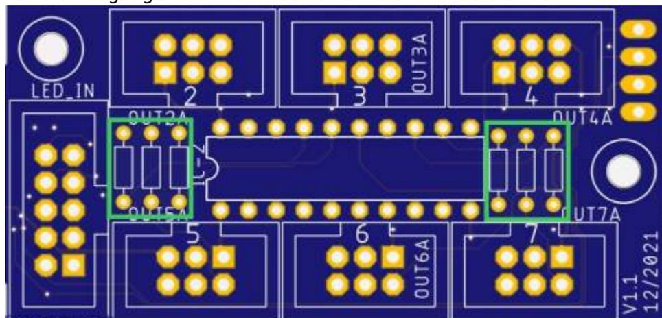
Um Platz zu sparen wurde diese nicht der Reihe nach auf der Platine verteilt. Die Zuordnung der Widerstände ist hier zu sehen.
