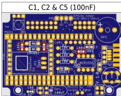
Nun folgt der IC1. Wer ein Step-Down-Modul mit eingelöteten Stiftleisten hat, kann diese am leichtesten auslöten, wenn man den Plastikteiler mit einem scharfen Messer oder kleinen Seitenschneider vorsichtig trennt. Danach lässt sich jeder der drei Stifte einzeln auslöten ohne größere Probleme.
