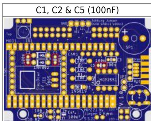
Nun folgt der IC1. Wer ein Step-Down-Modul mit eingelöteten Stiftleisten hat, kann diese am leichtesten auslöten, wenn man den Plastikteiler mit einem scharfen Messer oder kleinen Seitenschneider vorsichtig trennt. Danach lässt sich jeder der drei Stifte einzeln auslöten ohne größere Probleme.
