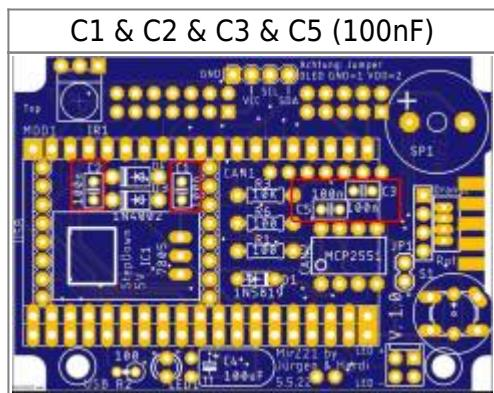
Nun folgt der IC1. Wer ein Step-Down-Modul mit eingelöteten Stiftleisten hat, kann diese an leichtesten auslösen, wenn man den Plastikteiler mit einem scharfen Messer oder kleinen Seitenschneider vorsichtig trennt. Danach lässt sich jeder der drei Stifte einzeln auslösen ohne größere Probleme.
