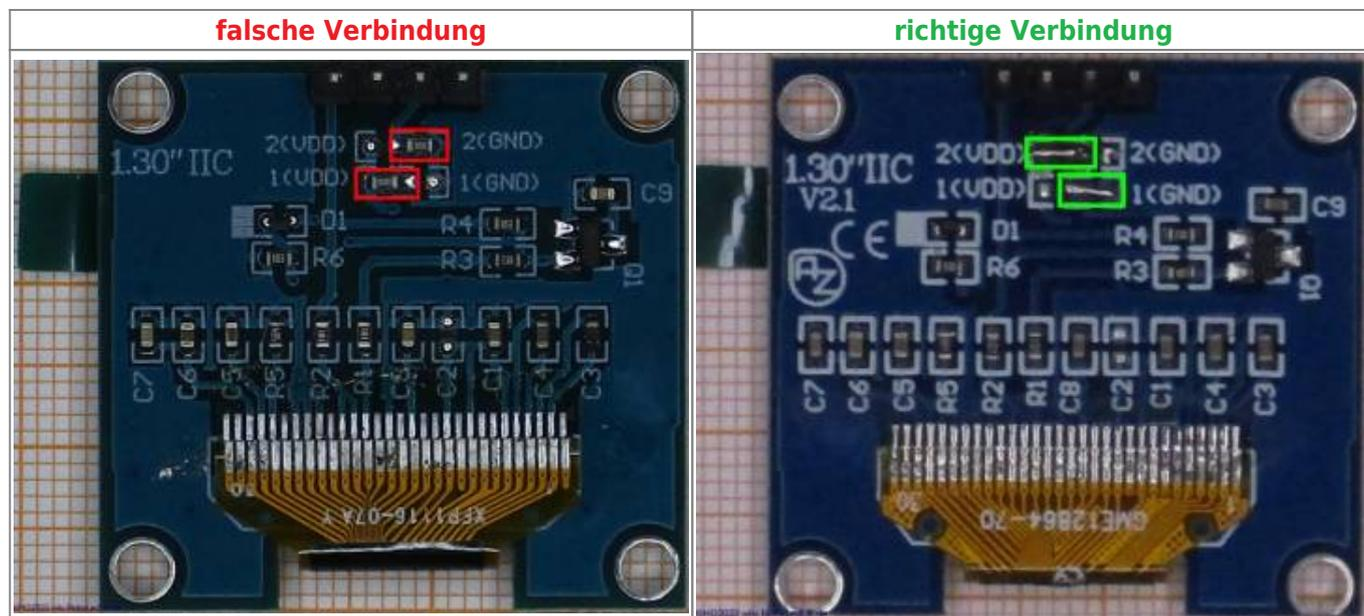
**MS2-Kabel Platinenversion 1.0 ----- Diese Version wird nicht mehr ausgeliefert!!**
