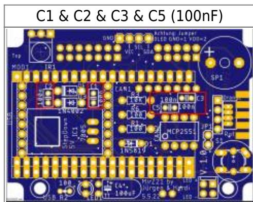
Nun folgt der IC1. Wer ein Step-Down-Modul mit eingelöteten Stiftleisten hat, kann diese an leichtesten auslöten, wenn man den Plastikteiler mit einem scharfen Messer oder kleinen Seitenschneider vorsichtig trennt. Danach lässt sich jeder der drei Stifte einzeln auslöten ohne größere Probleme.
