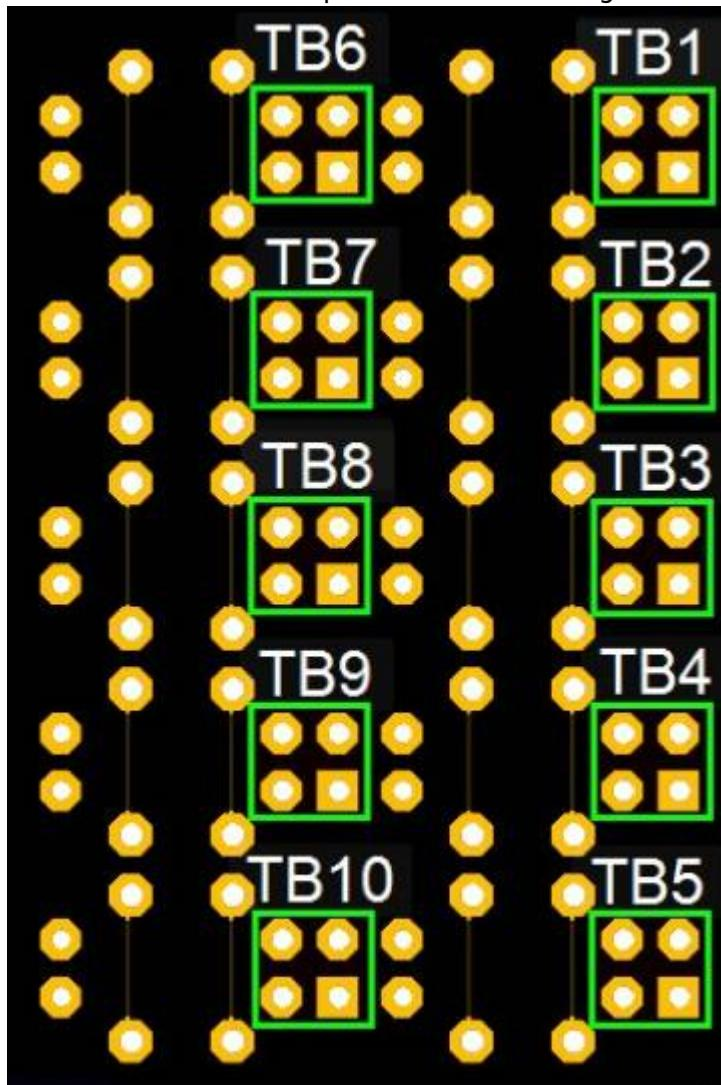
Sollten auf der Tasterplatine 6-polige Wannenstecker verwendet werden, dann ist zu beachten das dieses Taster-Testmodul richtig aufgesteckt wird. Hierzu müssen die 4-poligen Buchsen in die 4 Pins links in die Wannenstecker aufgesteckt werden.
