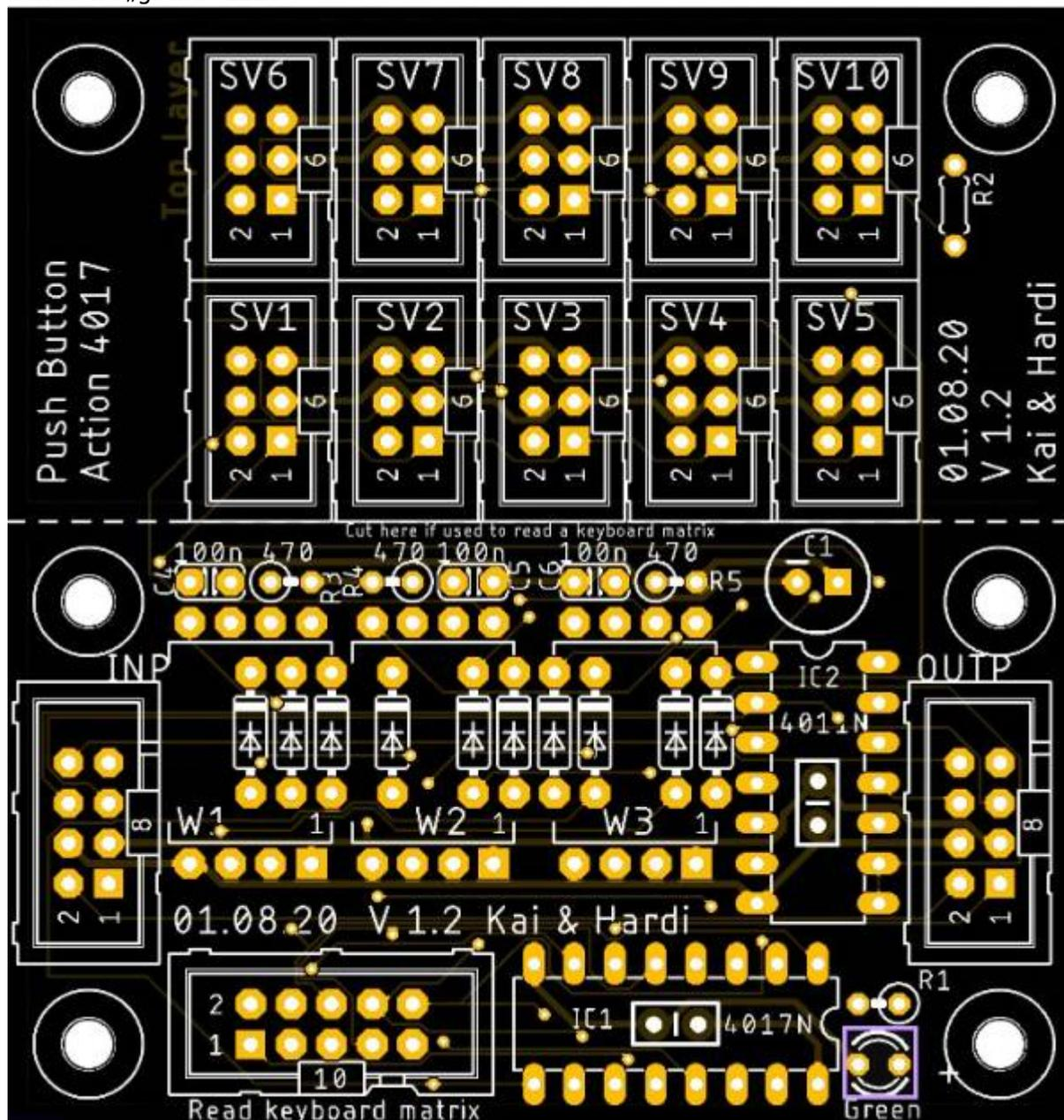
Den Abschluss macht der Elektrolytkondensator C1 (100µF).
