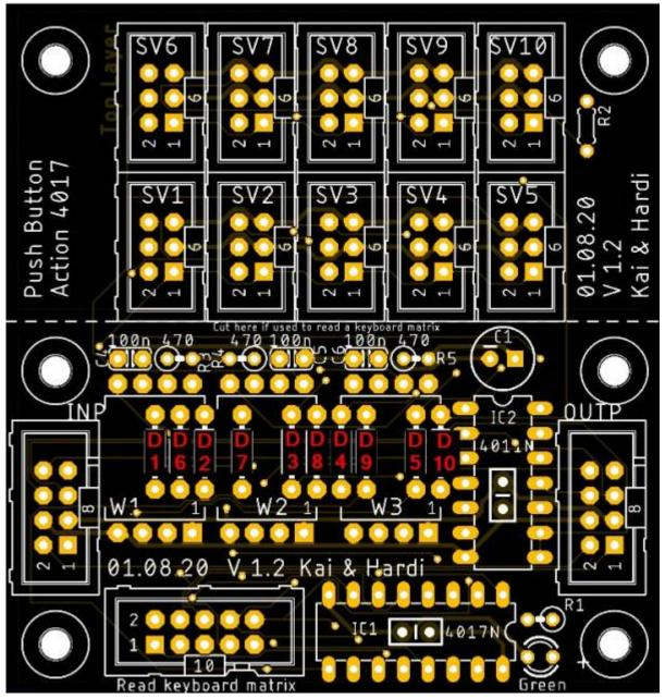
gefolgt von den Keramikkondensator C2 bis C6 (je 100nF)
