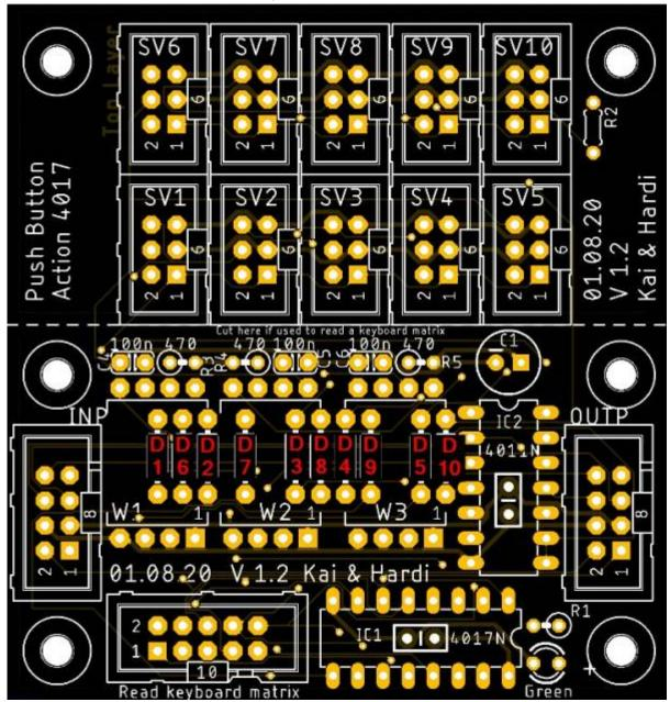
gefolgt von den beiden Keramikkondensator C2 & C3 (je 100nF)
