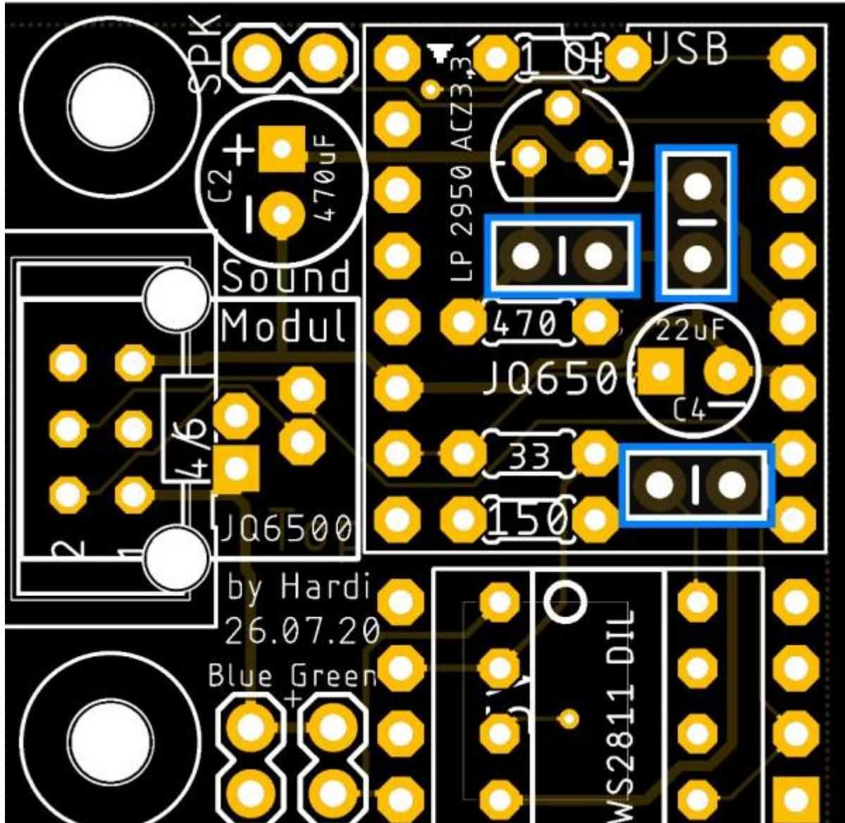
sowie die Widerstände R1 (1 Ω), R2 (150 Ω), R3 (470 Ω) und R4 (33 Ω). Da der Platz sehr knapp bemessen ist, müssen die Widerstände wie eine Rutsche eingelötet werden.
