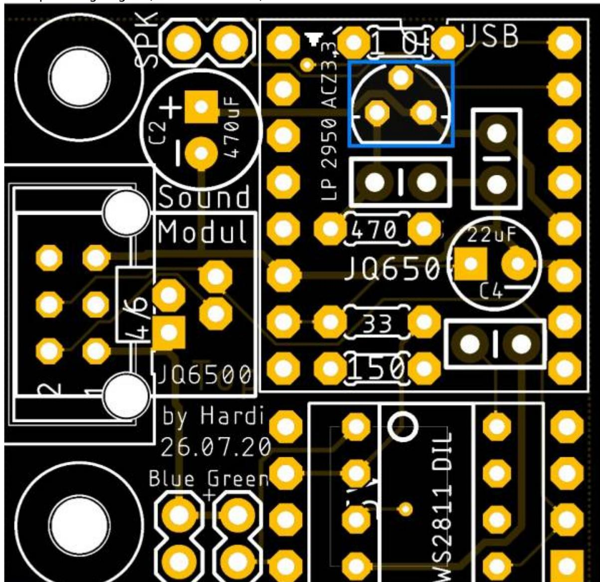
die beiden Eltrolytkeondensatoren C2 (470µF) und C4 (22µF)
