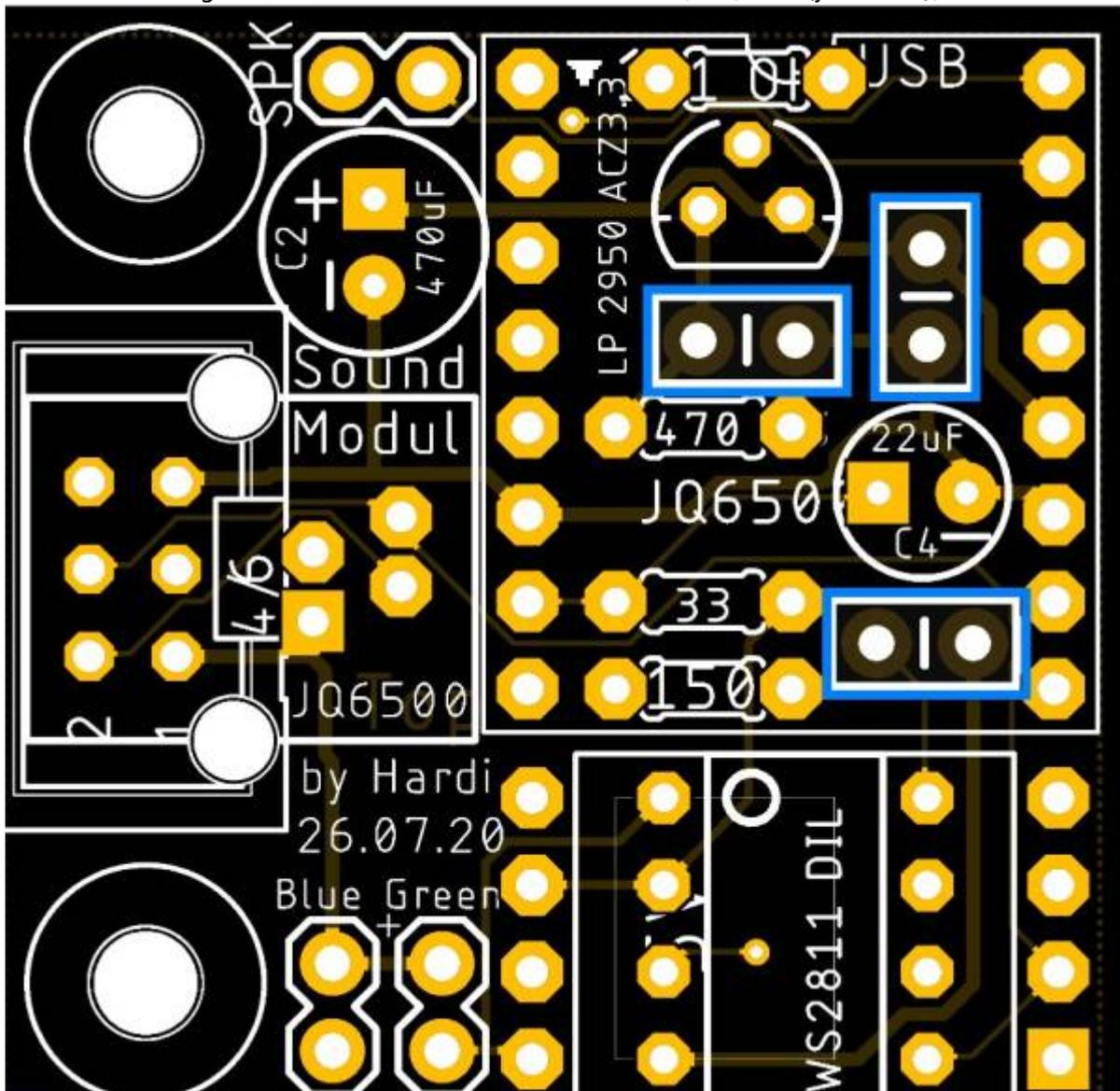
sowie die Widerstände R1 (1  $\Omega$ ), R2 (150  $\Omega$ ), R3 (470  $\Omega$ ) und R4 (33  $\Omega$ ). Da der Platz sehr knapp bemessen ist, müssen die Widerstände wie eine Rutsche eingelötet werden.
