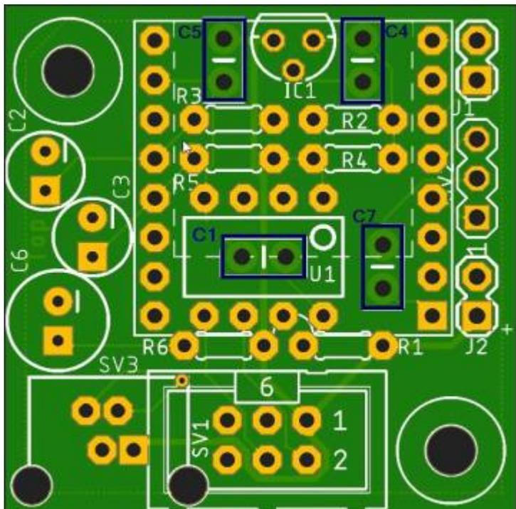
Nun kommen die 3 Elektrolytkondensator C2, C3 und C6 an die Reihe. Bei diesen muss die Polarität >wie bei der LED< beachtet werden. Dazu besitzt jeder Elko eine aufgedruckte Markierung für den Minuspol bzw für den Pluspol. Auf der Platine ist der Minuspol durch einen Strich markiert. Die Spannung von C2, C3 und C6 sollte mindestens 10V betragen <sup>4)</sup>.
