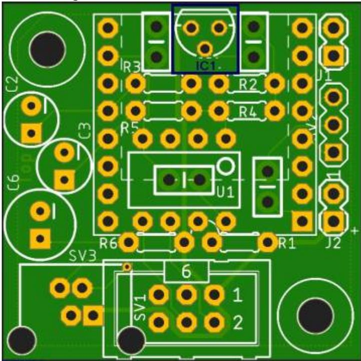
Im Anschluss folgen die vier Keramikcondensatoren (C1, C4, C5 und C7) auch diese müssen soweit wie möglich eingesteckt werden, andernfalls passen der Sockel für U1, sowie das Soundmodul später nicht in die Platine.
