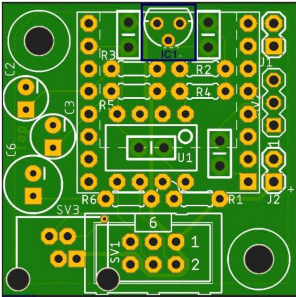
Im Anschluss folgen die vier Keramikkondensatoren (C4 -C7) auch diese müssen soweit wie möglich eingesteckt werden, andernfalls passen der Sockel für U1, sowie das Soundmodul später nicht in die Platine.
