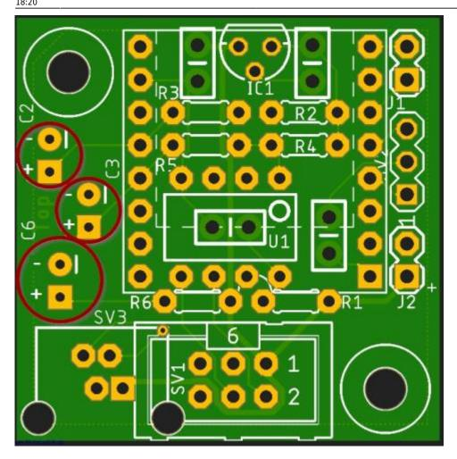
Nun wird noch der Sockel für U1, sowie die Buchsenleisten für das Soundmodul eingelötet. Pin 1 von U1 ist durch einen Kreis markiert.
