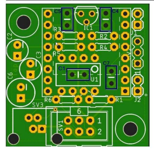
Nun kommen die 3 Elektrolytkondensator C2, C3 und C6 an die Reihe. Bei diesen muss die Polarität >wie bei der LED< beachtet werden. Dazu besitzt jeder Elko eine aufgedruckte Markierung für den Minuspol bzw für den Pluspol. Auf der Platine ist der Minuspol durch einen Strich markiert. Die Spannung von C2, C3 und C6 sollte mindestens 10V betragen <sup>2)</sup>.
