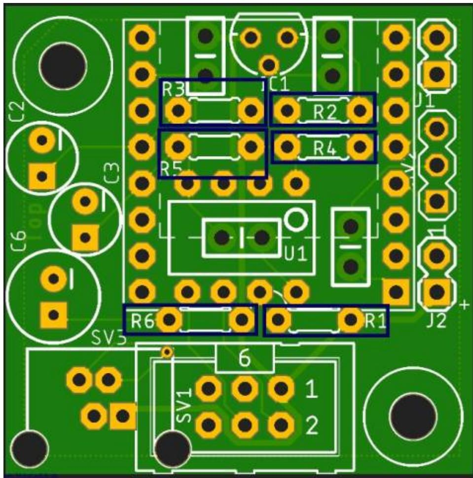
Als nächstes kommt nur IC1 an die Reihe. Diese wird wie aufgedruckt, soweit wie möglich, in die Platine eingesteckt. Dazu vorher den mittleren Pin etwas nach vorne biegen.
