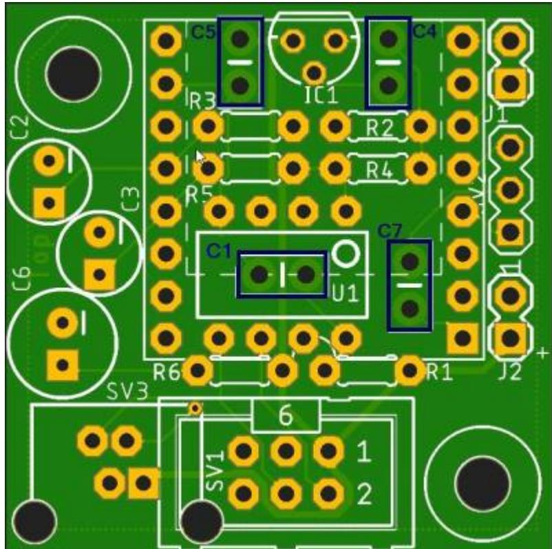
Nun kommen die 3 Elektrolytkondensatoren C2, C3 und C6 an die Reihe. Bei diesen muss die Polarität >wie bei der LED< beachtet werden. Dazu besitzt jeder Elko eine aufgedruckte Markierung für den Minuspol bzw für den Pluspol. Auf der Platine ist der Minuspol durch einen Strich markiert. Die Spannung von C2, C3 und C6 sollte mindestens 10V betragen <sup>2)</sup>.
