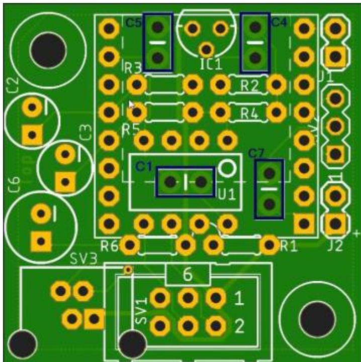
Nun kommen die 3 Elektrolytkondensatoren C2, C3 und C6 an die Reihe. Bei diesen muss die Polarität >wie bei der LED< beachtet werden. Dazu besitzt jeder Elko eine aufgedruckte Markierung für den Minuspol bzw für den Pluspol. Auf der Platine ist der Minuspol durch einen Strich markiert. Die Spannung von C2, C3 und C6 sollte mindestens 10V betragen <sup>4)</sup>.
