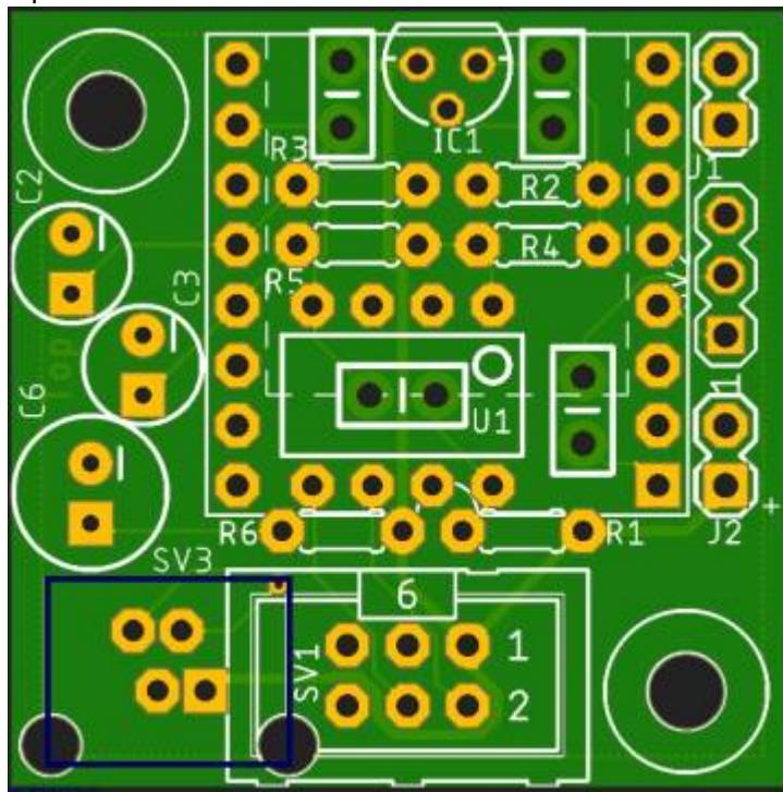
Für den Anschluss der LED (J2) und des Speakers (J1) wird je eine 2-polige Stiftleiste (gibt es in verschiedenen Längen/Ausführungen) verwendet, für den Aux-Out (SV2) wird eine 3-polige Buchsenleiste verwendet.
