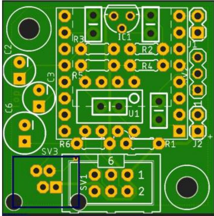
Für den Anschluss der LED (J2) und des Speakers (J1) wird je eine 2-polige Stifteleiste (gibt es in verschiedenen Längen/Ausführungen) verwendet, für den Aux-Out (SV2) wird eine 3-polige Buchsenleiste verwendet.
