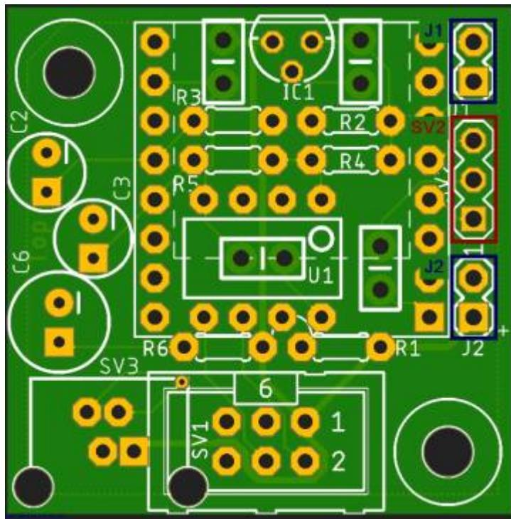
Zum Abschluss wird dann noch der WS2811 (U1), das Soundmodul aufgesteckt und der Lautsprecher mit dem Ausgang „Speaker“ verbunden.
