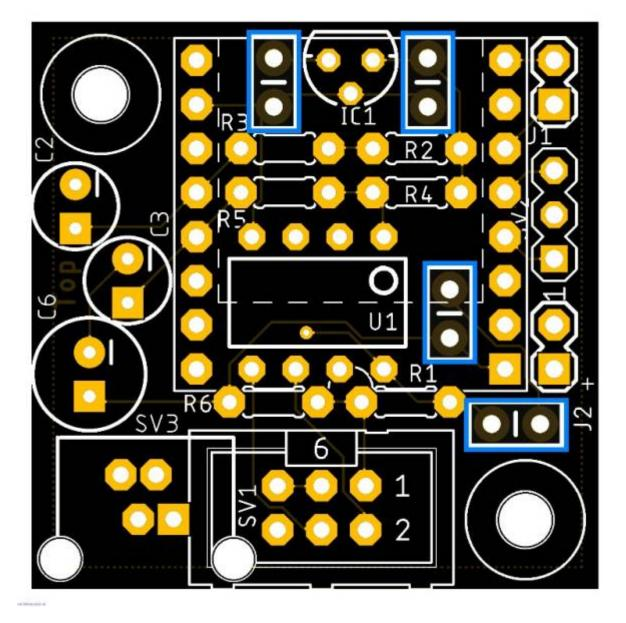
Als nächstes kommt nun IC1 an die Reihe. Diese wird wie aufgedruckt, soweit wie möglich, in die Platine eingesteckt. Dazu vorher den mittleren Pin etwas nach vorne biegen. Nun die IC-Fassung einlöten (rot markiert, wenn die DIL-Variante verwendet wird).
