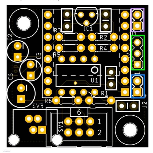
Nun kommen die drei Elektrolytkondensator C2, C3 ( $4.7\mu\text{F}$  oder  $22\mu\text{F}$ ) und C6 ( $470\mu\text{F}$ ) an die Reihe. Bei diesen muss die Polarität >wie bei der LED< beachtet werden. Dazu besitzt jeder Elko eine aufgedruckte Markierung für den Minuspol bzw für den Pluspol. Auf der Platine ist der Minuspol durch einen Strich markiert. Die Spannung von C2 und C3 sollte mindestens 10V betragen <sup>1)</sup>.
