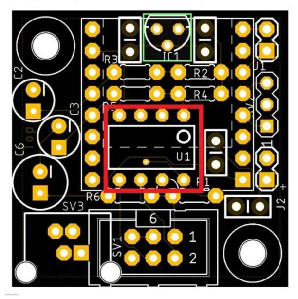
Weiter werden jetzt die Widerstände R1 (150  $\Omega$ ), R2 & R4 (1,50 K $\Omega$ ), R3 & R5 (33  $\Omega$ ), sowie R6 (1,00  $\Omega$ ) eingelötet. Da der Platz sehr knapp bemessen ist, müssen die Widerstände wie eine Rutsche eingelötet werden.
