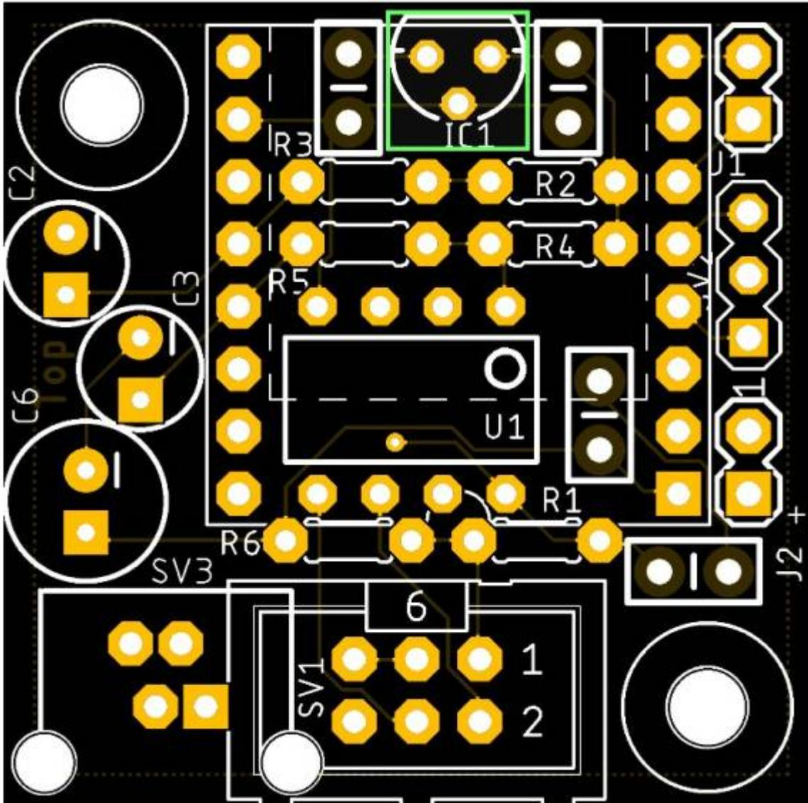
Im Anschluss folgen die vier Keramikkondensatoren (C1, C4, C5 und C7, je 100nF) auch diese müssen soweit wie möglich eingesteckt werden, andernfalls passt das Soundmodul später nicht in die Platine.
