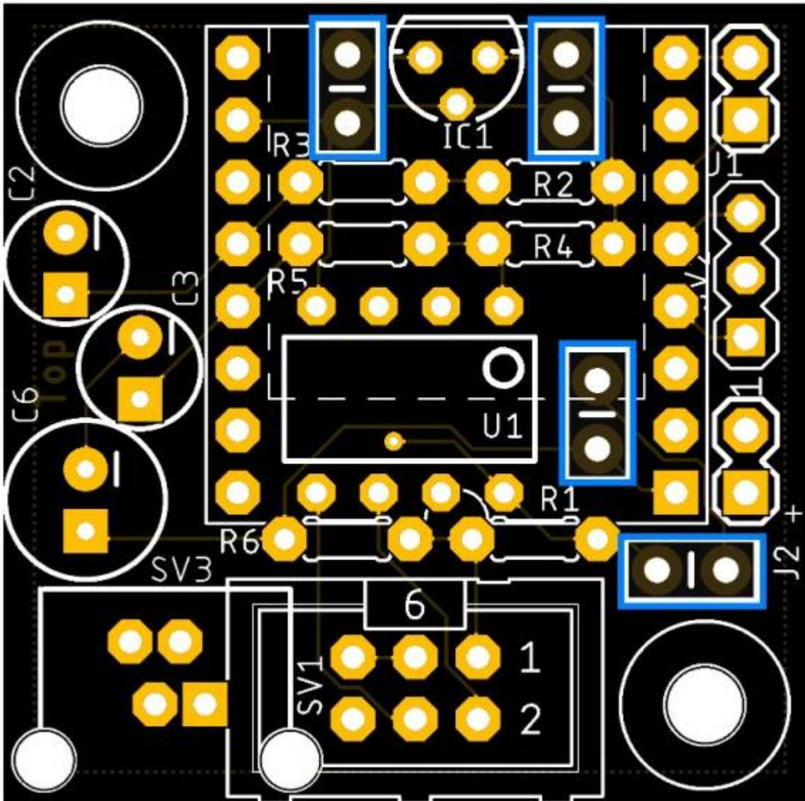
Nun kommen die drei Elektrolytkondensator C2, C3 (22 $\mu$ F) und C6 (470 $\mu$ F) an die Reihe. Bei diesen muss die Polarität >wie bei der LED< beachtet werden. Dazu besitzt jeder Elko eine aufgedruckte Markierung für den Minuspol bzw für den Pluspol. Auf der Platine ist der Minuspol durch einen Strich markiert. Die Spannung von C2 und C3 sollte mindestens 10V betragen <sup>1)</sup>.
