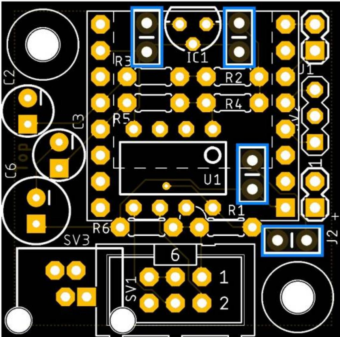
Nun kommen die drei Elektrolytkondensator C2, C3 (4.7 $\mu$ F) und C6 (470 $\mu$ F) an die Reihe. Bei diesen muss die Polarität >wie bei der LED< beachtet werden. Dazu besitzt jeder Elko eine aufgedruckte Markierung für den Minuspol bzw für den Pluspol. Auf der Platine ist der Minuspol durch einen Strich markiert. Die Spannung von C2 und C3 sollte mindestens 10V betragen <sup>1)</sup>.
