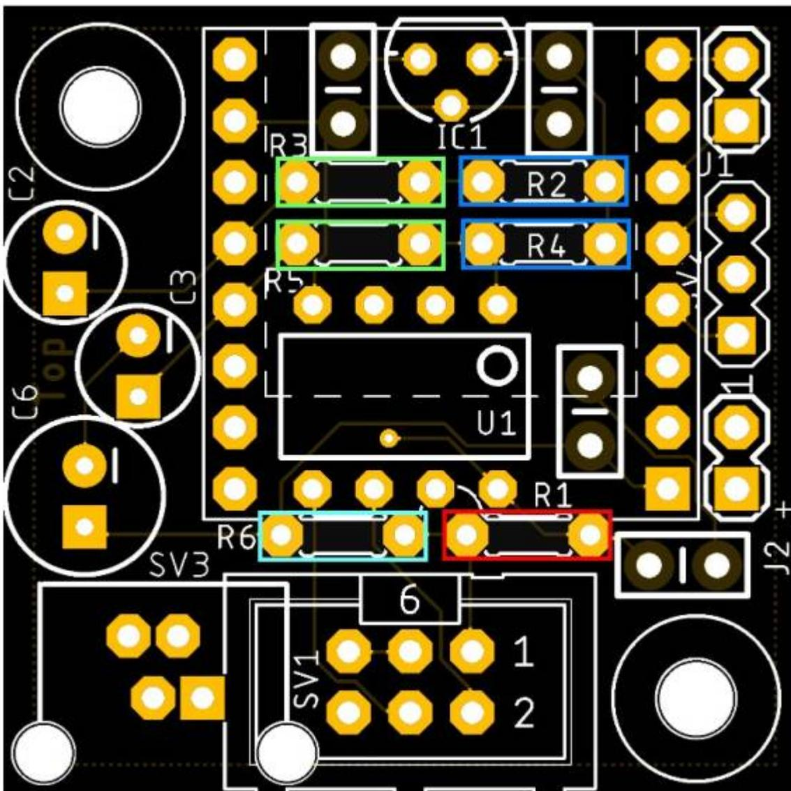
Als nächstes kommt nun IC1 an die Reihe. Diese wird wie aufgedruckt, soweit wie möglich, in die Platine eingesteckt. Dazu vorher den mittleren Pin etwas nach vorne biegen.
