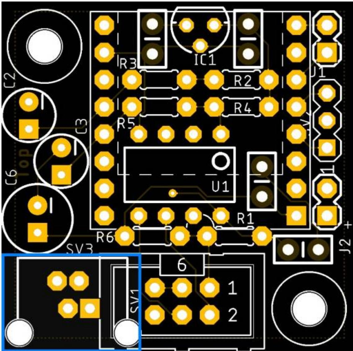
Für den Anschluss der LED (J2, blau) wird eine zweipolige Buchsenleiste und für Speaker (J1, violett) wird eine 2-polige Stiftleiste (gibt es in verschiedenen Längen/Ausführungen) verwendet, für den Aux-Out (SV2, gruen) wird eine 3-polige Buchsenleiste verwendet.
