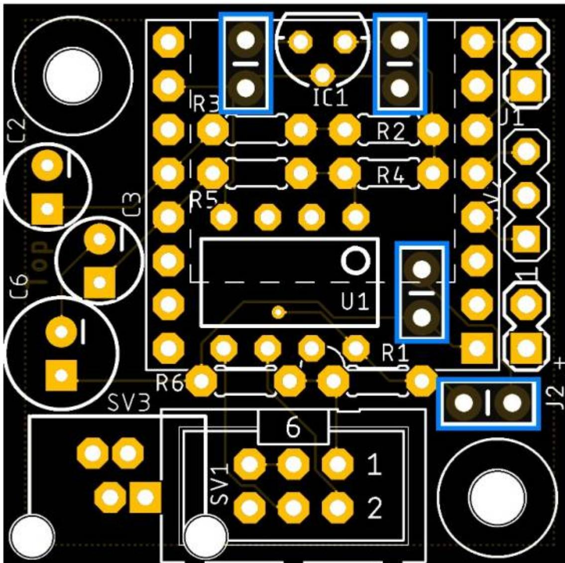
Nun kommen die drei Elektrolytkondensator C2, C3 (4.7µF) und C6 (470µF) an die Reihe. Bei diesen muss die Polarität >wie bei der LED< beachtet werden. Dazu besitzt jeder Elko eine aufgedruckte Markierung für den Minuspol bzw für den Pluspol. Auf der Platine ist der Minuspol durch einen Strich markiert. Die Spannung von C2 und C3 sollte mindestens 10V betragen <sup>1)</sup>.
