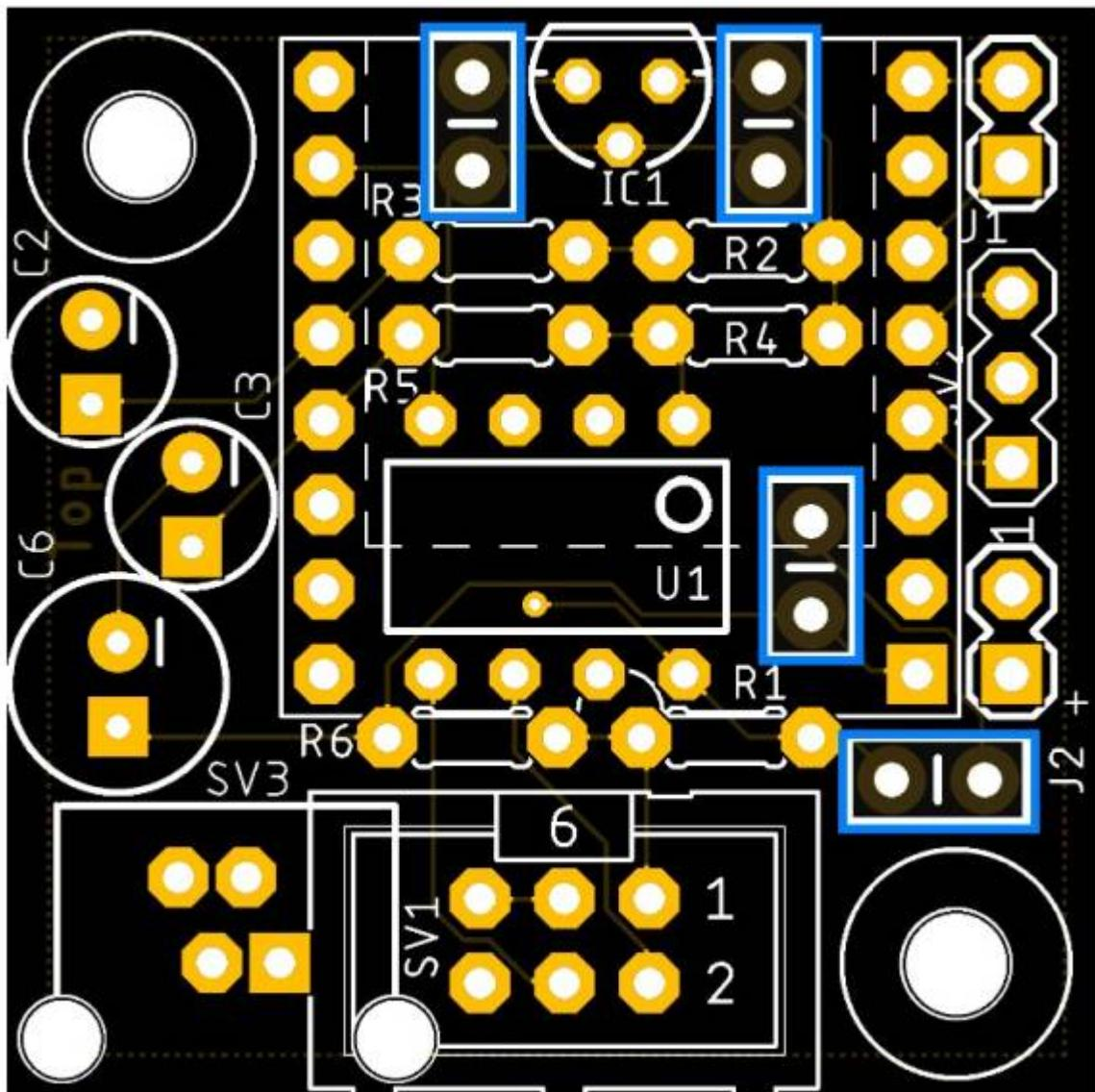
Nun kommen die drei Elektrolytkondensator C2, C3 (4.7µF oder 22µF) und C6 (470µF) an die Reihe. Bei diesen muss die Polarität >wie bei der LED< beachtet werden. Dazu besitzt jeder Elko eine aufgedruckte Markierung für den Minuspol bzw für den Pluspol. Auf der Platine ist der Minuspol durch einen Strich markiert. Die Spannung von C2 und C3 sollte mindestens 10V betragen <sup>1)</sup>.
