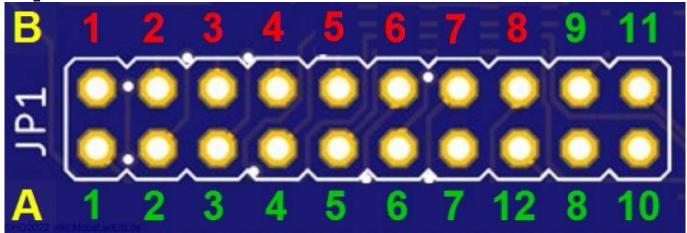
Auf der Unterseite befinden sich unterhalb des Kanaljumpers "JP1" die Defaultlötjumper. Damit die Änderung der Pins auf der Oberseite funktioniert müssen diese getrennt werden mit einem scharfen Messer. Um das in einem Rutsch machen zu können wurde der gesamte Bereich frei von Leiterbahnen gehalten.
