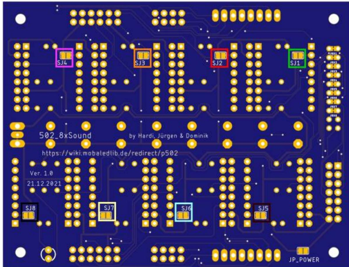
Zusätzlich gibt es dort auch noch den Lötjumper „JP\_Power“. Dieser kann geschlossen werden, wenn die Hauptplatine über das Soundmodul mit 5V versorgt werden soll bzw die Soundmodule über die Huptplatine ihren Strom erhalten sollen.
