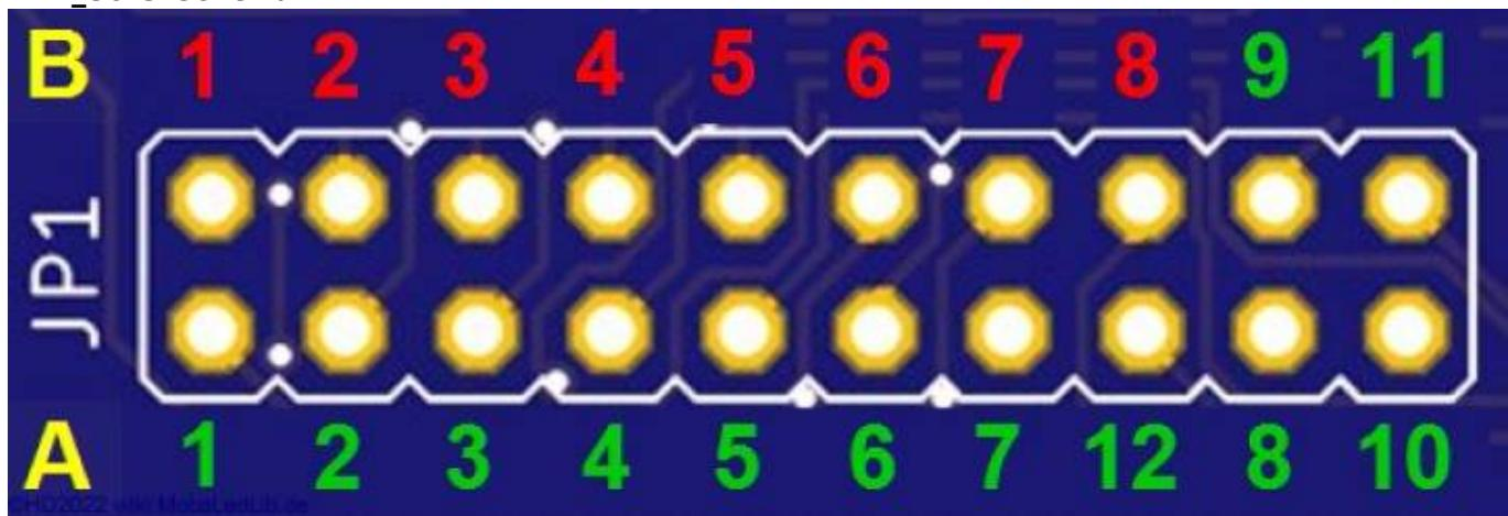
Auf der Unterseite befinden sich unterhalb des Kanaljumpers „JP1“ die Defaultlötzjumper. Damit die Änderung der Pins auf der Oberseite funktioniert müssen diese getrennt werden mit einem scharfen Messer. Um das in einem Rutsch machen zu können wurde der gesamte Bereich frei von Leiterbahnen gehalten.
