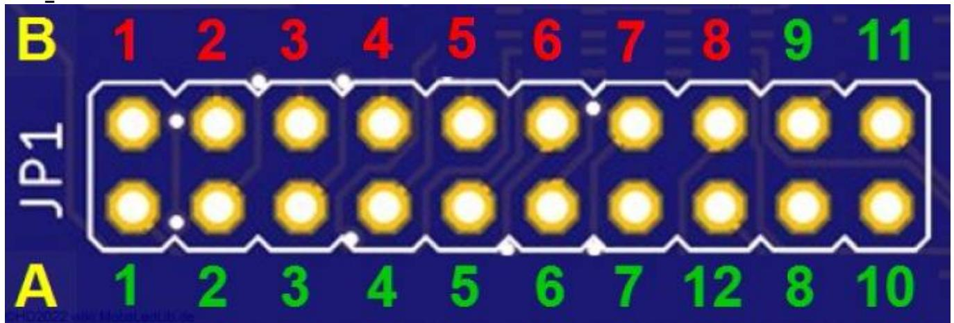
Auf der Unterseite befinden sich unterhalb des Kanaljumpers „JP1“ die Defaultlötzjumper. Damit die Änderung der Pins auf der Oberseite funktioniert müssen diese getrennt werden mit einem scharfen Messer. Um das in einem Rutsch machen zu können wurde der gesamte Bereich frei von Leiterbahnen gehalten.
