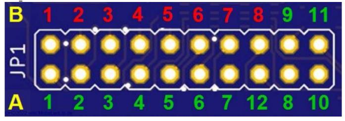
Auf der Unterseite befinden sich unterhalb des Kanaljumpers "JP1" die Defaultlötjumper. Damit die Änderung der Pins auf der Oberseite funktioniert müssen diese getrennt werden mit einem scharfen Messer. Um das in einem Rutsch machen zu können wurde der gesamte Bereich frei von Leiterbahnen gehalten.
