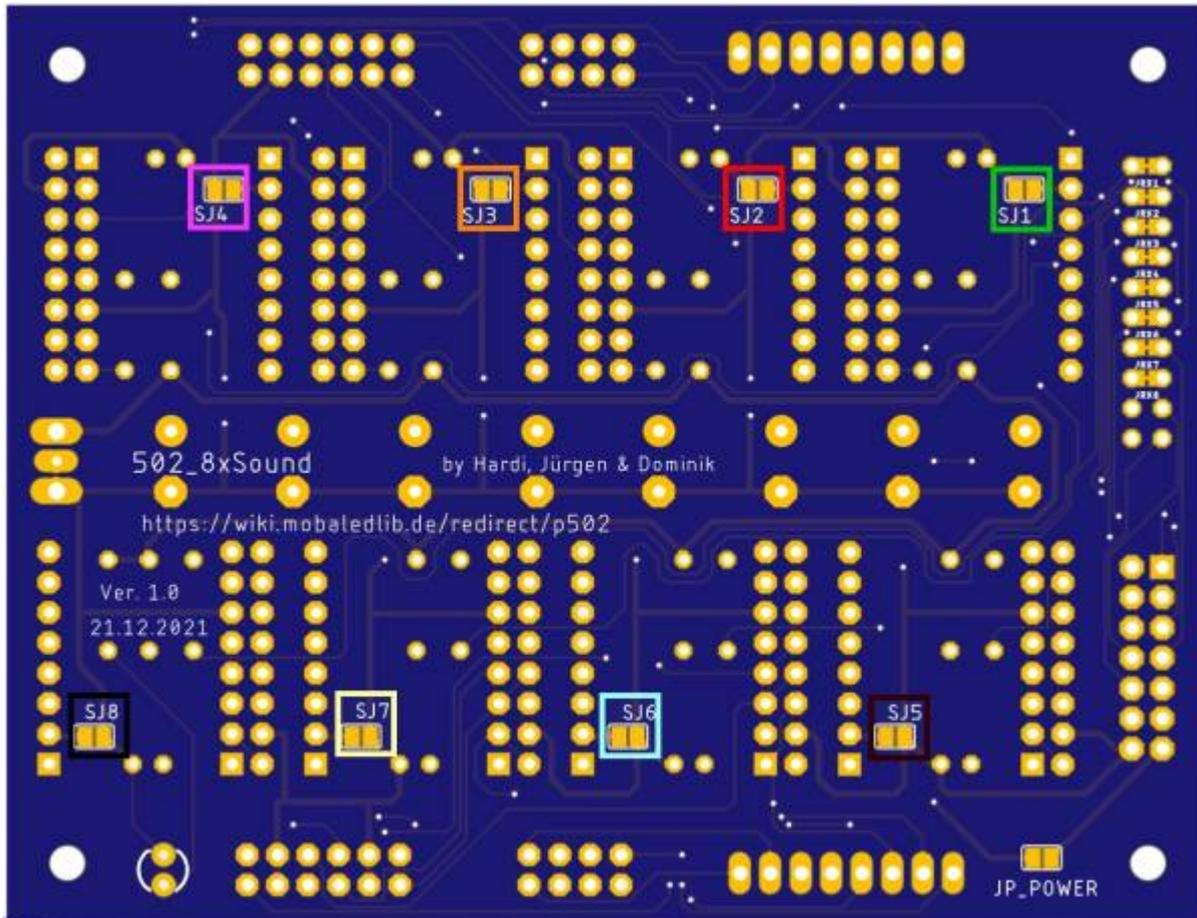
Zusätzlich gibt es dort auch noch den Lötjumper „JP\_Power“. Dieser kann geschlossen werden, wenn die Hauptplatine über das Soundmodul mit 5V versorgt werden soll bzw die Soundmodule über die Hauptplatine ihren Strom erhalten sollen.
