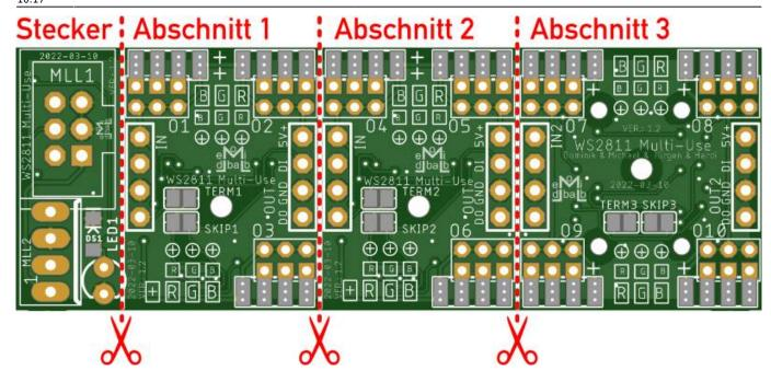
Jeder der drei WS2811-Abschnitte (1-3) kann einzeln oder am Stück mit den beiden benachbarten Abschnitten (1-3) zwischen WS2812b-LEDs oder WS2811 Schokoladen-Chips zum Einsatz kommen.
