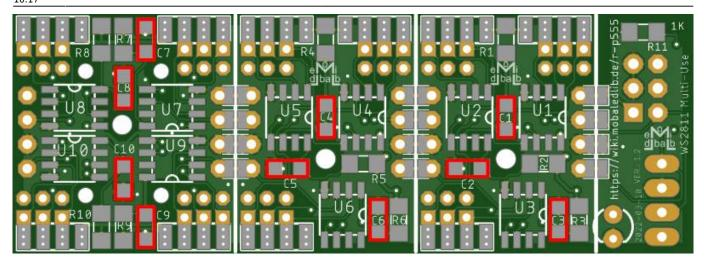
Zum Schluss folgen die zehn Widerstände R1 - R10 mit 150 $\Omega$ , sowie R11 mit 1k $\Omega$
