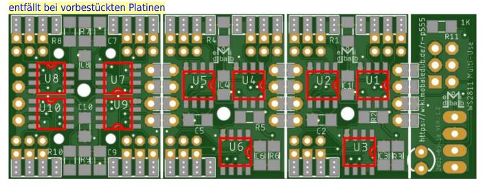
Nun folgen die zehn Kondensatoren C1 bis C10 mit jeweils 100nF. entfällt bei vorbestückten Platinen
