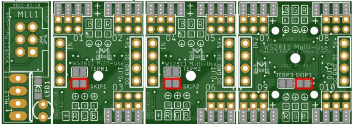
Die drei Lötjumper "Term" zum Verbinden des letzten WS2811 mit dem Data Out der beiden Stecker:
