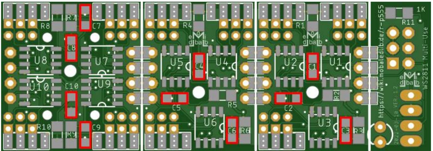
Zum Schluss folgen die zehn Widerstände R1 - R10 mit 150Ω, sowie R11 mit 1kΩ
