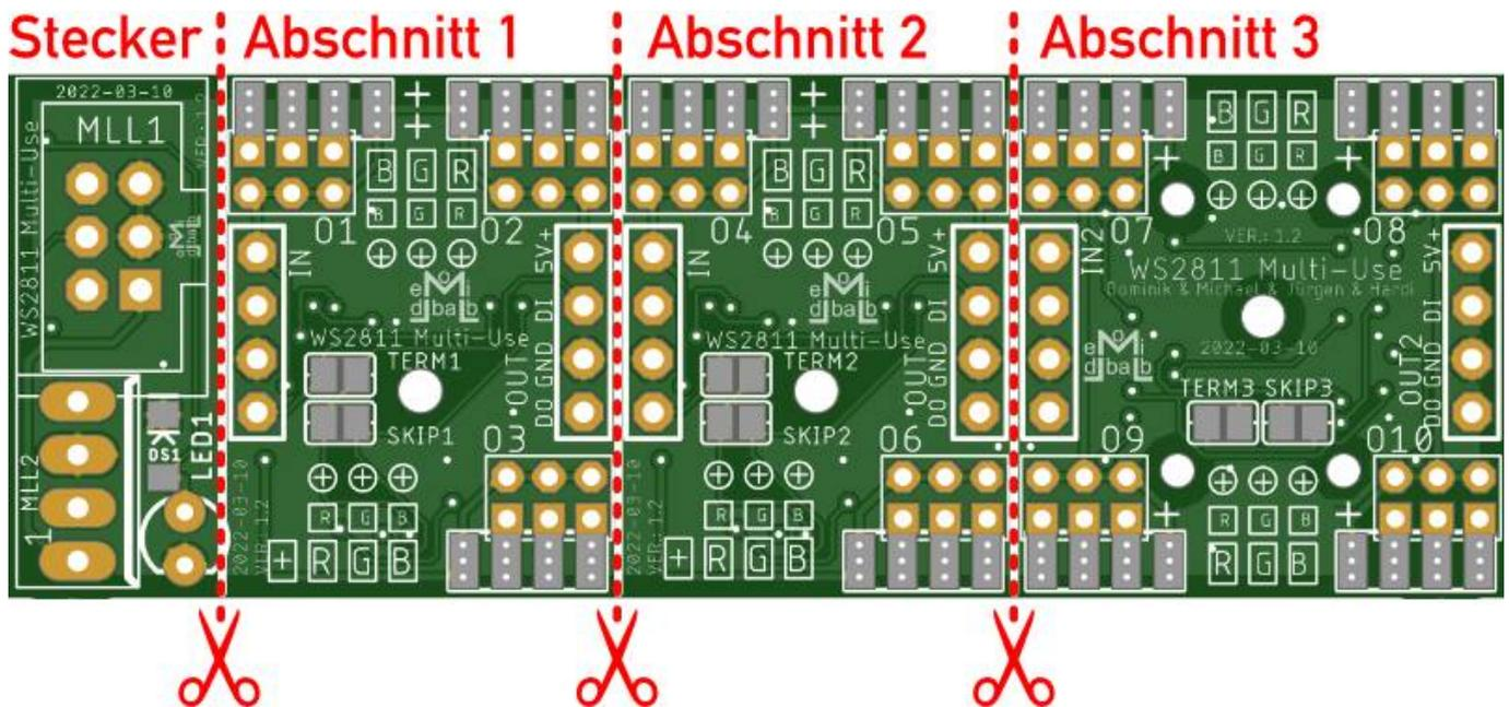
Jeder der drei WS2811-Abschnitte (1-3) kann einzeln oder am Stück mit den beiden benachbarten Abschnitten (1-3) zwischen WS2812b-LEDs oder WS2811 Schokoladen-Chips zum Einsatz kommen.
