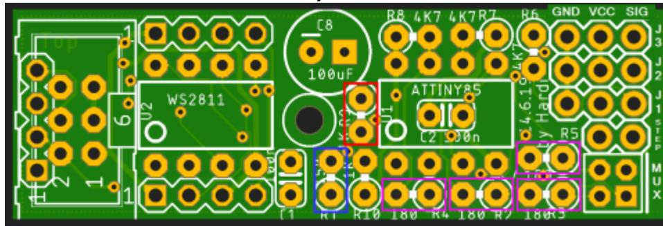
Für den Ausgang der Moduls wird eine 2x2-polige Stifteleiste mit einem Rastermaß von 2.00 mm verwendet. Die passenden Stecker sind z.B.: [hier bei "Distrelec" erhältlich](#).
