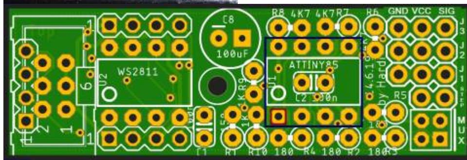
Nun folgt, wenn man sich für die DIP-Variante entschieden hat, das einlöten von dem 8-Pin-Sockel für U2. Die Markierung am Sockel/IC ist auf dem Bild wieder hervorgehoben. Sollte man sich für die SMD-Variante entschieden haben, bleibt der Sockel leer. U3 wird auf der Unterseite der Platine aufgelötet. Dieser Vorgang wird [hier](#) weiter unten beschrieben.
