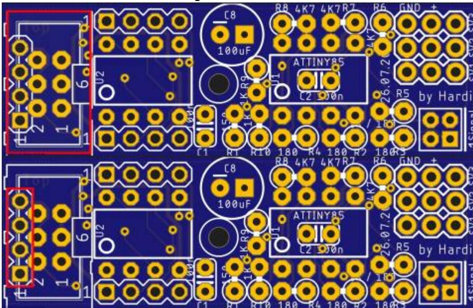
Das letzte Bauteil das noch fehlt ist der Elektrolytkondensator C8. Bei diesem bitte auf die Polung achten. Der Minuspol ist am Kondensator und auf der Platine markiert.
