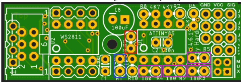
Für den Ausgang der Moduls wird eine 2x2-polige Stiftleiste mit einem Rastermaß von 2.00 mm verwendet. Die passenden Stecker sind z.B.: [hier bei "Distrelec" erhältlich](#).
