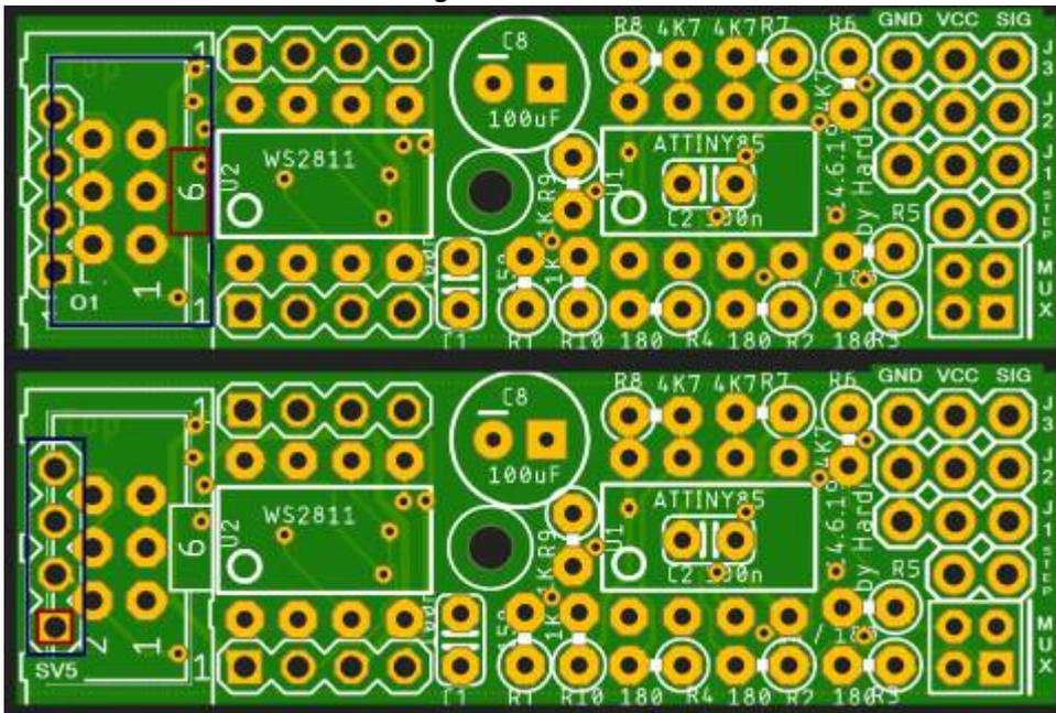
Das letzte Bauteil das noch fehlt ist der Elektrolytkondensator C8. Bei diesem bitte auf die Polung achten. Der Minuspol ist am Kondensator und auf der Platine markiert.
